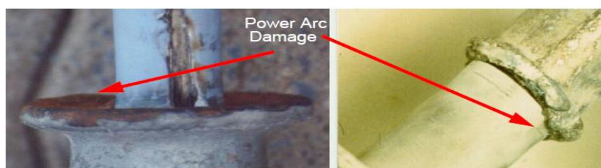
Σχήμα 1.34: Βλάβη στο μεταλλικό άκρο του μονωτήρα [39].
