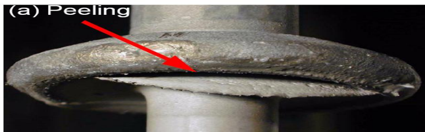
Σχήμα 1.33: Βλάβη στη διεπιφάνεια μεταξύ του πολυμερούς περιβλήματος και της εσοχής του (σφράγισμα) λόγω αποκόλλησής του [39].
