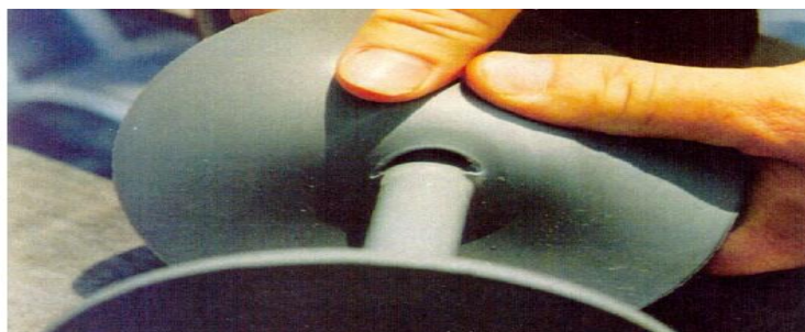
Σχήμα 1.28: Αλλοίωση στη διεπιφάνεια μεταξύ δίσκου και περιβλήματος του μονωτήρα [39].
