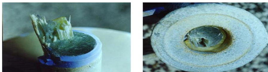
Σχήμα 1.42: Μηχανική αστοχία πυρήνα μονωτήρα από ίνες σκληρυμένης υάλου [39].
