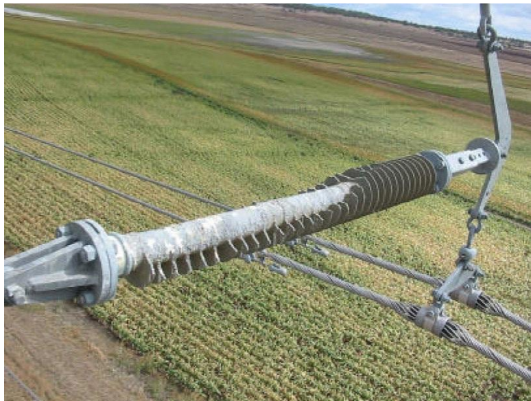
Σχήμα 1.21: Συνθετικός μονωτήρας 110 kV, το πολυμερές περίβλημα και οι ελαστομερείς δίσκοι του οποίου έχουν δεχθεί «επίθεση» ιδιαίτερος λαίμαργων, καθώς φαίνεται, πτηνών [30].
