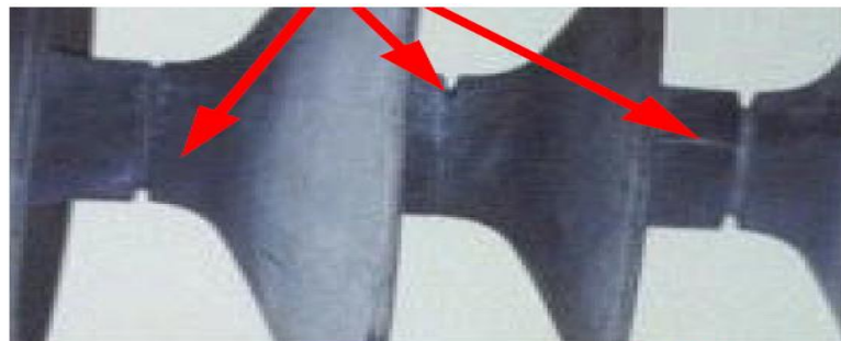
Σχήμα 1.31: Βλάβη στο πολυμερές περίβλημα εξαιτίας της μη συναρμογής των διαφορετικών μερών του μονωτήρα [39].
