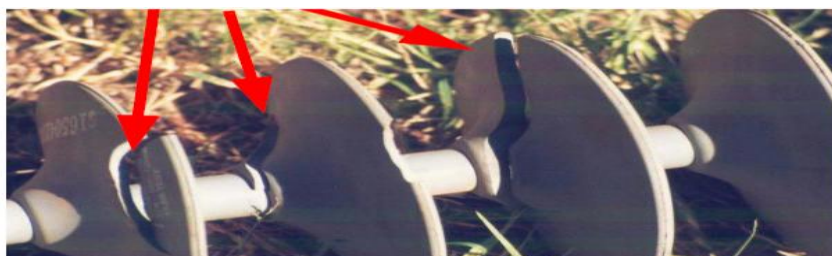
Σχήμα 1.38: Βλάβη στους δίσκους μονωτήρα με μείωση του μήκους ερπυσμού >10% από σπάσιμο [39].
