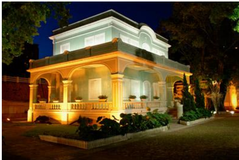
Εικόνα 3.18: Φωτισμός κτιρίου με λαμπτήρες εκκένωσης. Πηγή: http://urbngreen.com/?m=200806
