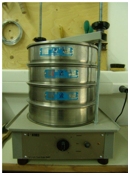
Σχήμα 2.12 Συσκευή δόνησης με κόσκινα.
