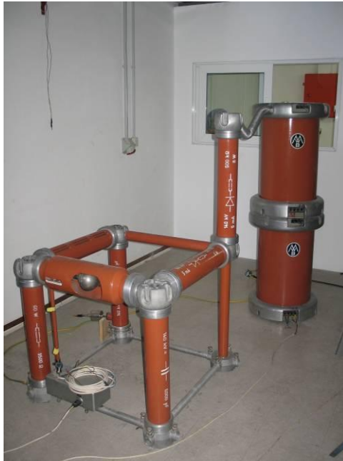
Σχήμα 2.2 Λυόμενη μονοβάθμια κρουστική γεννήτρια.
