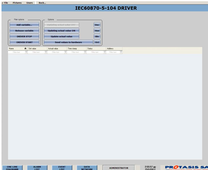
Εικόνα 2.31: Οθόνη VARIABLE TEST του SCADA
