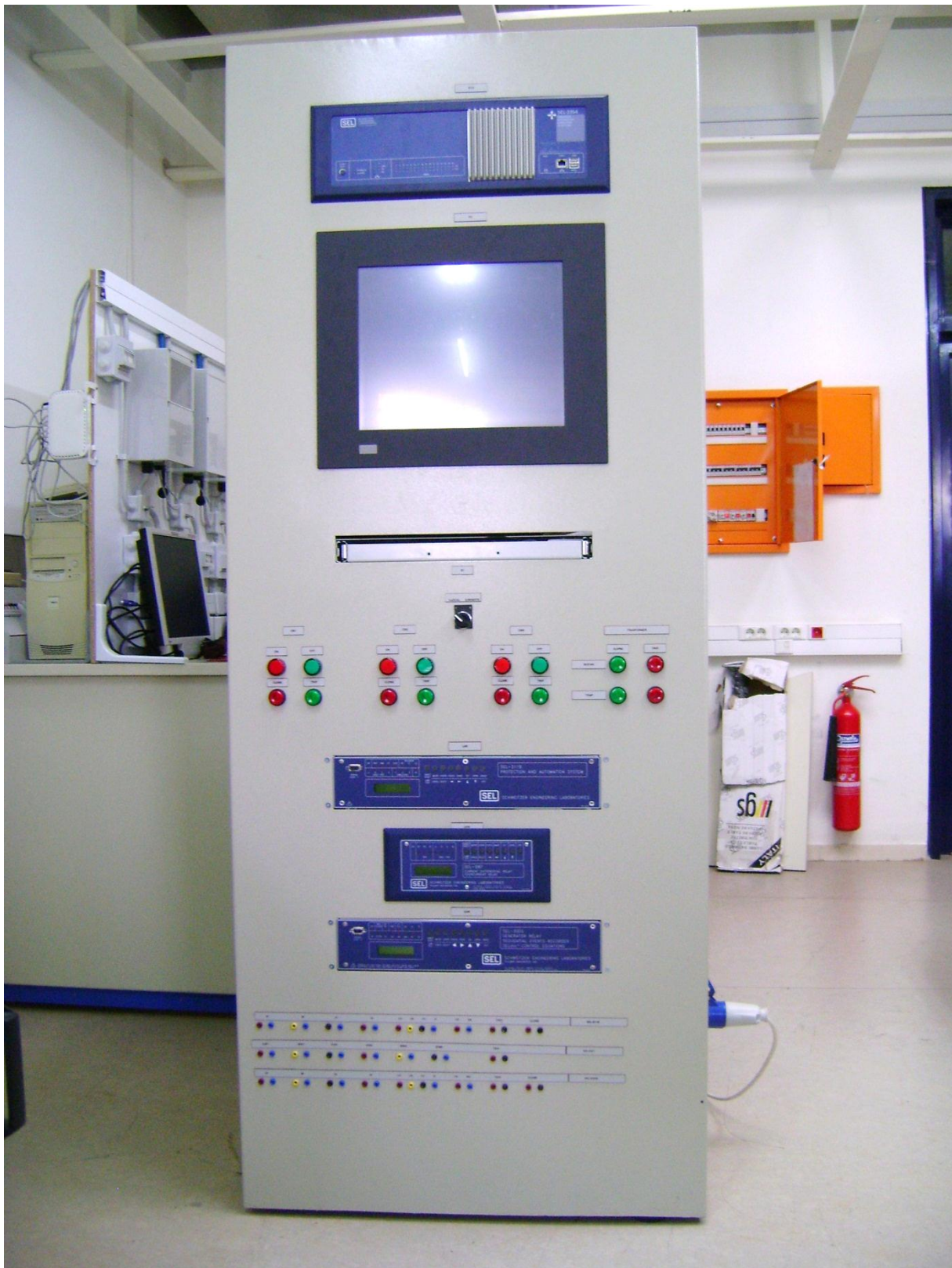
Εικόνα 2.1: Πρόσθια όψη εργαστηριακού συστήματος προστασίας
