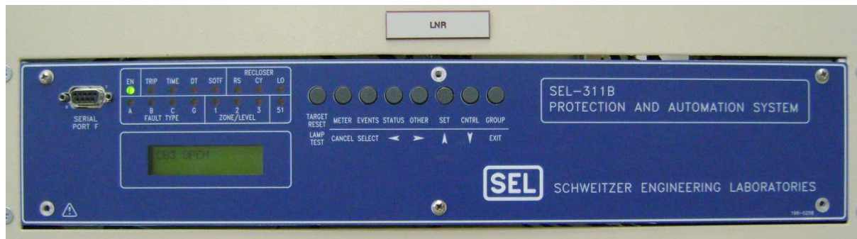
Εικόνα 2.52: Πρόσθια όψη ηλεκτρονόμου SEL-311B
