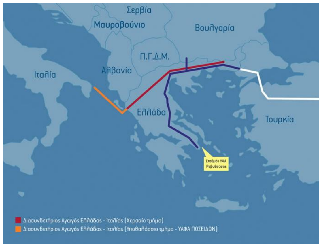
Σχήμα 6.4: Δίκτυο μεταφοράς ΦΑ ITGI
