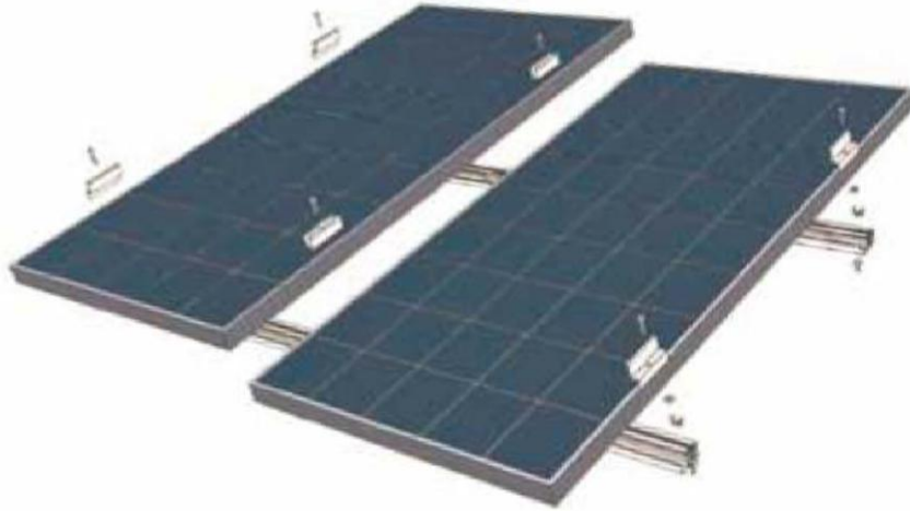
Εικόνα 4.11: Σταθερές βάσεις για σκεπές
