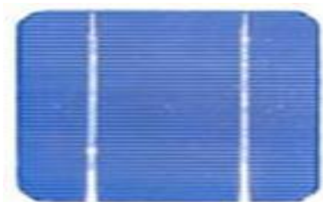
Εικόνα 3.4 - Μονοκρυσταλλικό ηλιακό κελί.
