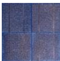
Εικόνα 3.6: Κελί ταινίας πυριτίου (Ribbon Silicon)
