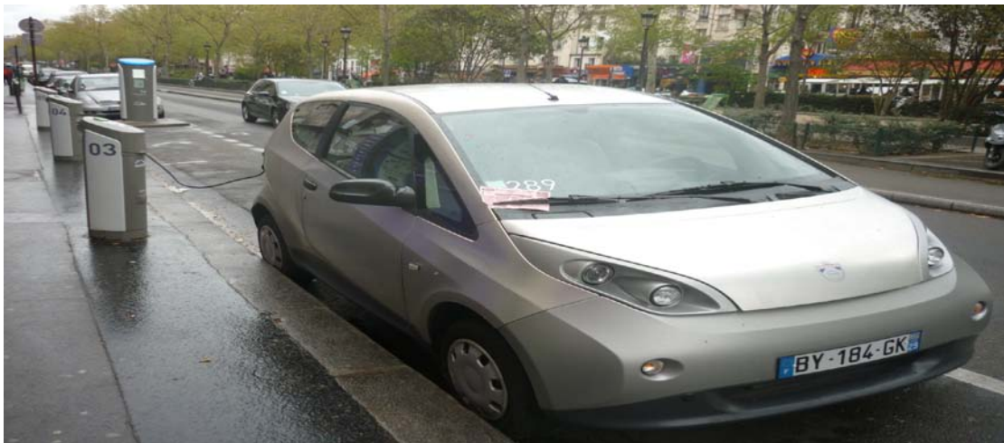
Εικόνα 18:σταθμός ενσύρματης φόρτισης στο Παρίσι
