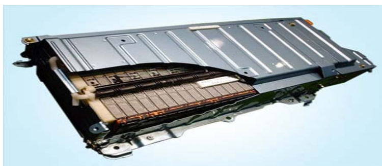
Εικόνα 14: συσσωρευτής νικελίου -μετάλλου υδριδίου από το υβριδικό αυτοκίνητο Toyota Prius
