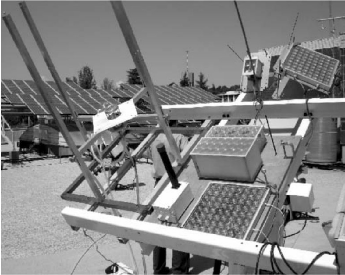
Εικ. 3.3. Δυναμικό σύστημα παρακολούθησης στο IES πάνω στο οποίο τοποθετούνται πληθώρα διαφορετικών CPV για μέτρηση ετήσιας ηλεκτρικής παραγωγής καθώς και αξιοπιστίας κάτω από πραγματικές συνθήκες σε πραγματικό χρόνο.
