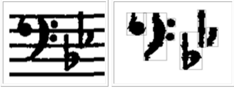
Εικόνα 2. 1: Αριστερά φαίνεται το απόσπασμα της αρχικής παρτιτούρας, δεξιά το αποτέλεσμα μετά την αφαίρεση των γραμμών. Τα μουσικά στοιχεία που έχουν αναγνωριστεί ως διαφορετικά, περικλείονται από διαφορετικό κουτί. Στη συνέχεια τα κουτιά που θεωρείται ότι αφορούν στο ίδιο στοιχείο συνενώνονται (δεν απεικονίζεται) [26]
