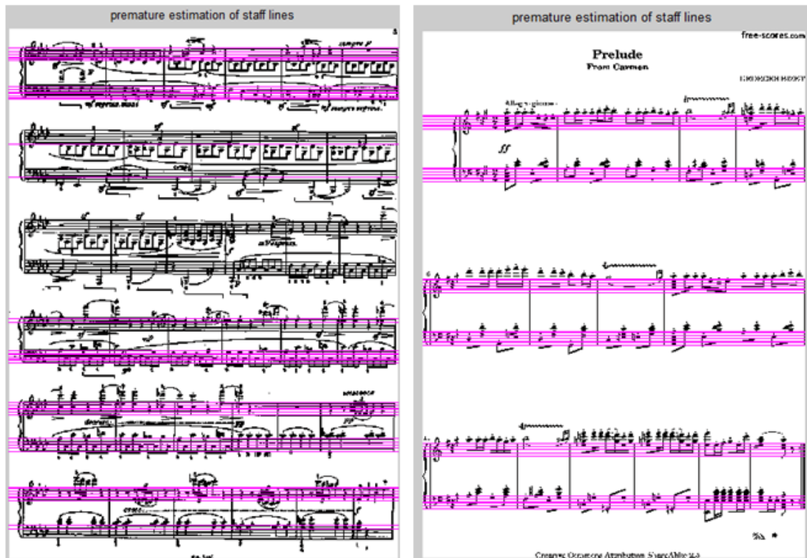
Εικόνα 3. 9: Από αριστερά: Beethoven Sonata, σελίδα 3, [46] και Bizet Carmen Prelude, σελίδα 1, [47], δείγματα αρχικής εκτίμησης γραμμών, όπου η αριστερή εικόνα είναι χαμηλής ποιότητας, μικρού μεγέθους και scanned, ενώ η δεξιά είναι υψηλής ποιότητας, μεγάλου μεγέθους και born digital.
