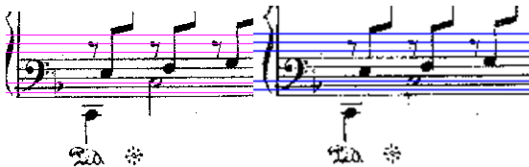
Εικόνα 3. 55: Το πρόβλημα της μη κατάταξης των γραμμών του ίδιου πενταγράμμου στο ίδιο πεντάγραμμο, παρά το αυστηρότερο κατώφλι. Αριστερά φαίνεται το αποτέλεσμα μετά την εκτίμηση γραμμών και δεξιά το πρόβλημα που παραμένει, μετά την πρώτη διαδικασία του σταδίου αυτού, εξαιτίας της απόστασης μεταξύ των ομάδων γραμμών που είναι μεγαλύτερη από το κατώφλι που χρησιμοποιείται ( 3 \cdot \text{staff-line-distance} ). Schumann Novelletes, σελίδα 3 [10]
