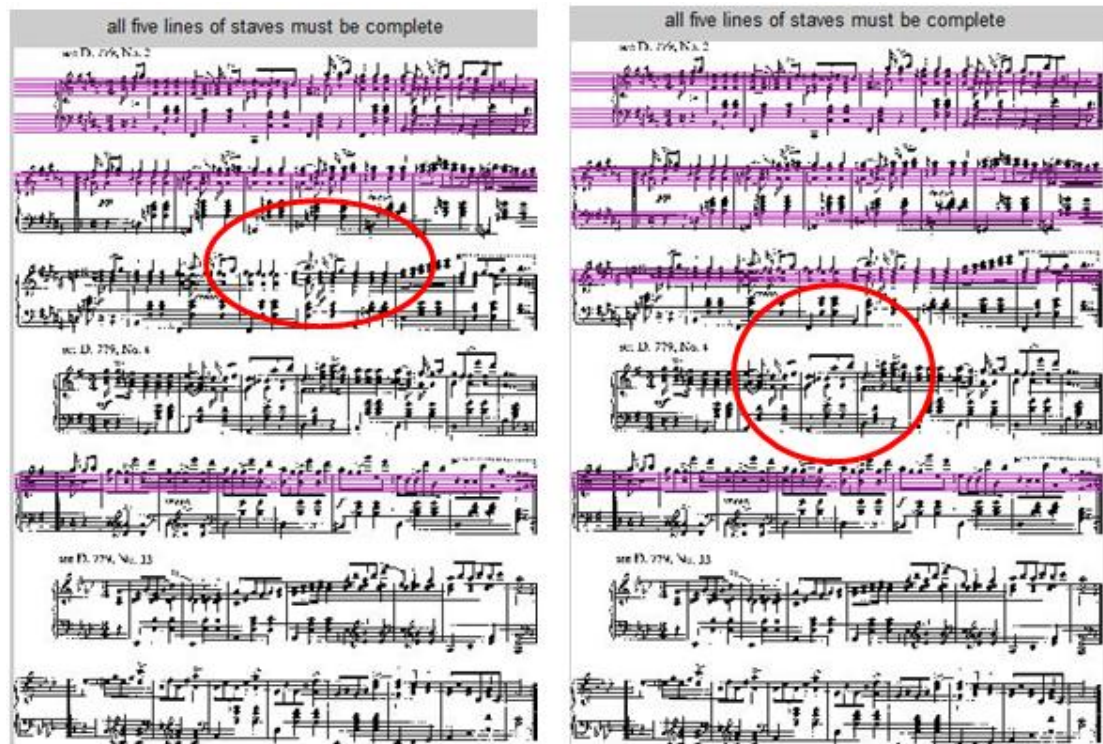
Εικόνα 3. 34: Διαδοχικά στιγμιότυπα εντοπισμού γραμμών πενταγράμμου, με κύκλο έχει επισημανθεί η περιοχή που μεταβάλλεται ή αναμένεται να μεταβληθεί. Αριστερά: Ο αλγόριθμος θα διερευνήσει τη μοναδική μεγάλη απόσταση μεταξύ διαδοχικών πενταγράμμων, Δεξιά: Εντοπίζονται ταυτόχρονα δύο πεντάγραμμα και συμπληρώνονται οι γραμμές των νέων πενταγράμμων, η επόμενη προς διερεύνηση απόσταση φαίνεται κυκλωμένη, Schubert Waltzes, σελίδα 4 [50].
