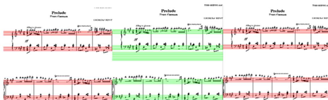
Εικόνα 3. 38: Εντοπισμός μη πραγματικού πενταγράμμου (κέντρο) και στη συνέχεια διόρθωση (δεξιά) λόγω της πολύ μεγάλης απόστασης μεταξύ των διαδοχικών συστημάτων σε born digital παρτιτούρα. Ο εντοπισμός των επιπλέον γραμμών θα είχε αποφευχθεί αν γίνονταν χρήση ενός χαμηλότερου κατωφλίου αποδοχής (πιο μαύρες γραμμές), αλλά εξαιτίας της χρήσης ενιαίου μεγαλύτερου κατωφλίου τόσο για scanned όσο και για born digital παρτιτούρες, εμφανίζεται το παραπάνω φαινόμενο, Bizet Carmen Prelude, [47]
