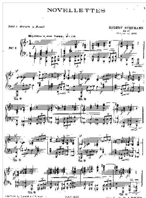
Εικόνα 3. 6: Αποτέλεσμα κατωφλίωσης με χρήση χαμηλότερου κατωφλίου για τη μετατροπή της εικόνας εισόδου σε ασπρόμαυρη την παρτιτούρα που παρουσιάστηκε στην Εικόνα 3.5. Είναι φανερή η επίδραση του κατωφλίου στο τελικό αποτέλεσμα: οι διαφορετικές περιοχές που εμφανίζονται στο υπόβαθρο έχουν αντικατασταθεί με ενιαίο άσπρο χρώμα, Schumann Novelletes, σελίδα 1, [10]
