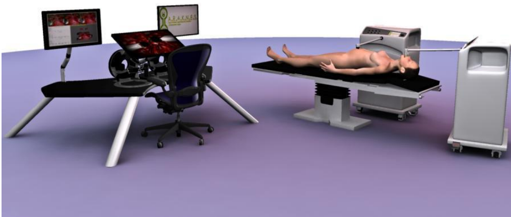
Εικόνα 106 : Από αριστερά προς τα δεξιά: οθόνες απεικόνισης, bi manual ελεγκτής (χειριστήρια), χειρουργικό κρεβάτι , μονάδα κοιλιακής προσπέλασης και μονάδα οισοφαγικής προσπέλασης[75].
