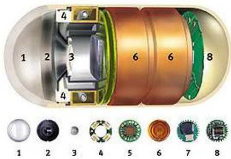
Εικόνα 94 : Δομή κάψουλας Pill Cam
