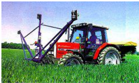
Σχήμα 5.3 Λίπανση ακριβείας σε πραγματικό χρόνο, με τη χρήση αισθητήρα [25]
