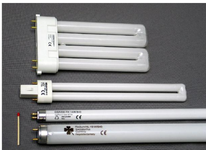
Εικόνα 2.4 : Λαμπτήρες φθορισμού. Από πάνω προς τα κάτω, οι 2 πρώτοι είναι συμπαγείς, ο τρίτος T5 και ο τέταρτος T8.
