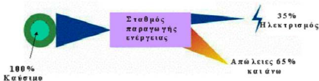
ΕΙΚΟΝΑ 3.24.: ΠΑΡΑΔΟΣΙΑΚΟ ΣΥΣΤΗΜΑ ΗΛΕΚΤΡΟΠΑΡΑΓΩΓΗΣ.
