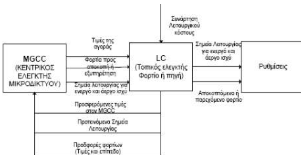
ΕΙΚΟΝΑ 6.6.: Η ΡΟΗ ΠΛΗΡΟΦΟΡΙΑΣ ΜΕΤΑΞΥ ΤΟΥ ΚΕΝΤΡΙΚΟΥ ΕΛΕΓΚΤΗ ΚΑΙ ΤΩΝ ΤΟΠΙΚΩΝ ΕΛΕΓΚΤΩΝ ΣΕ ΕΝΑ ΜΙΚΡΟΔΙΚΤΥΟ.
