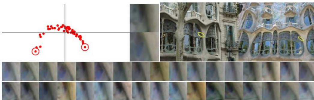
Σχήμα 5.4: Ένα παράδειγμα με αντίστοιχα patches. Μία προβολή PCA των περιγραφέων στο χώρο δύο διαστάσεων· με τον κόκκινο κύκλο τα 2 πιο μακρινά patches (αριστερά)· τα δύο πιο διακριτά patches στο χώρο των περιγραφέων SIFT και οι φωτογραφίες που προέρχονται (δεξιά); Ένα σύνολο από όμοια patches(κάτω).
