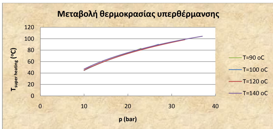
Σχήμα 4.31 Μεταβολή της θερμοκρασίας υπερθέρμανσης για R152a
