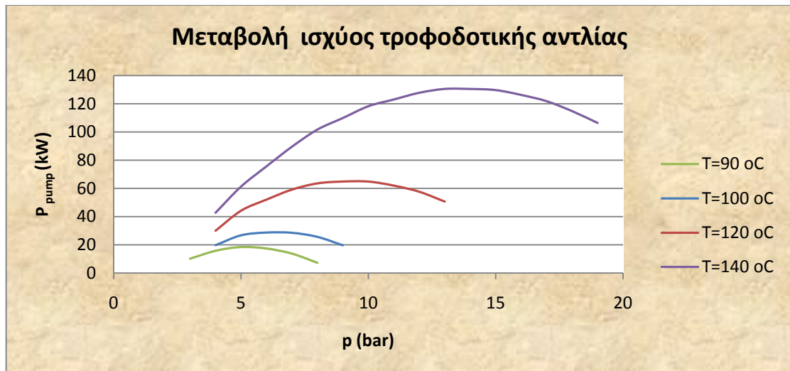
Σχήμα 4.37 Μεταβολή της ισχύος τροφοδοτικής αντλίας για R245fa
