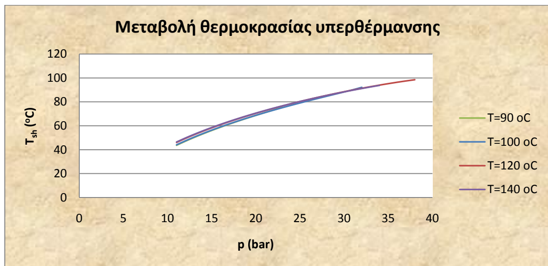
Σχήμα 4.23 Μεταβολή της θερμοκρασίας υπερθέρμανσης για R134a
