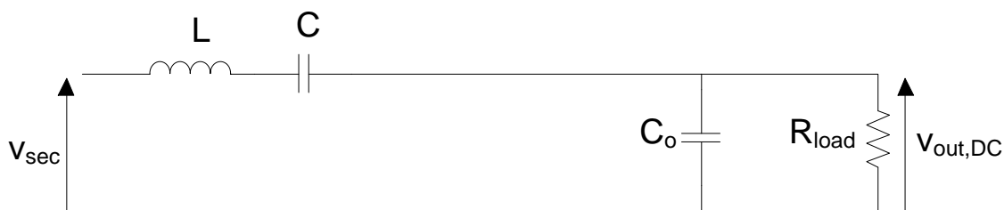
Σχήμα 3.34. Ισοδύναμο κύκλωμα ημιανορθωτή στη θετική ημιπερίοδο της τάσης εισόδου
