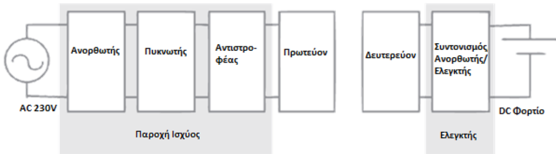
Σχήμα 1.5. Μονοφασικό διάγραμμα βαθμίδων συστήματος επαγωγικής μεταφοράς ισχύος [40]
