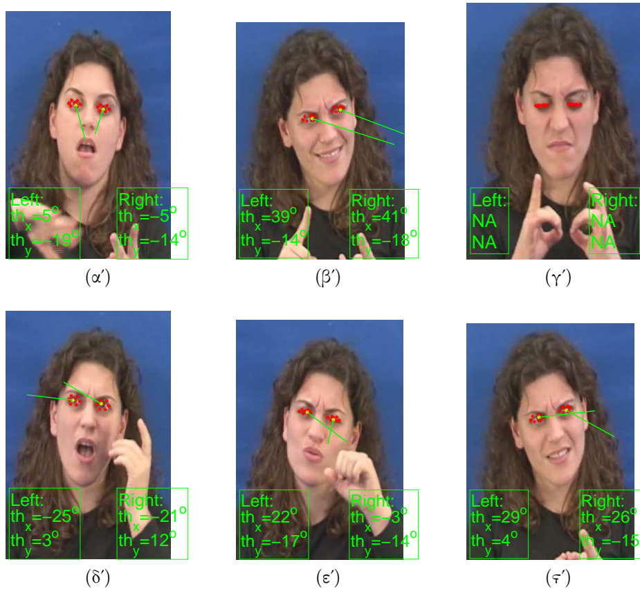
Σχήμα 4.15: Παραδείγματα εφαρμογής του γεωμετρικού μοντέλου εκτίμησης του eye gaze, με εύρεση της θέσης της ίριδας χρησιμοποιώντας μορφολογικό φιλτράρισμα, για τη βάση δεδομένων της ENG του IEL.
