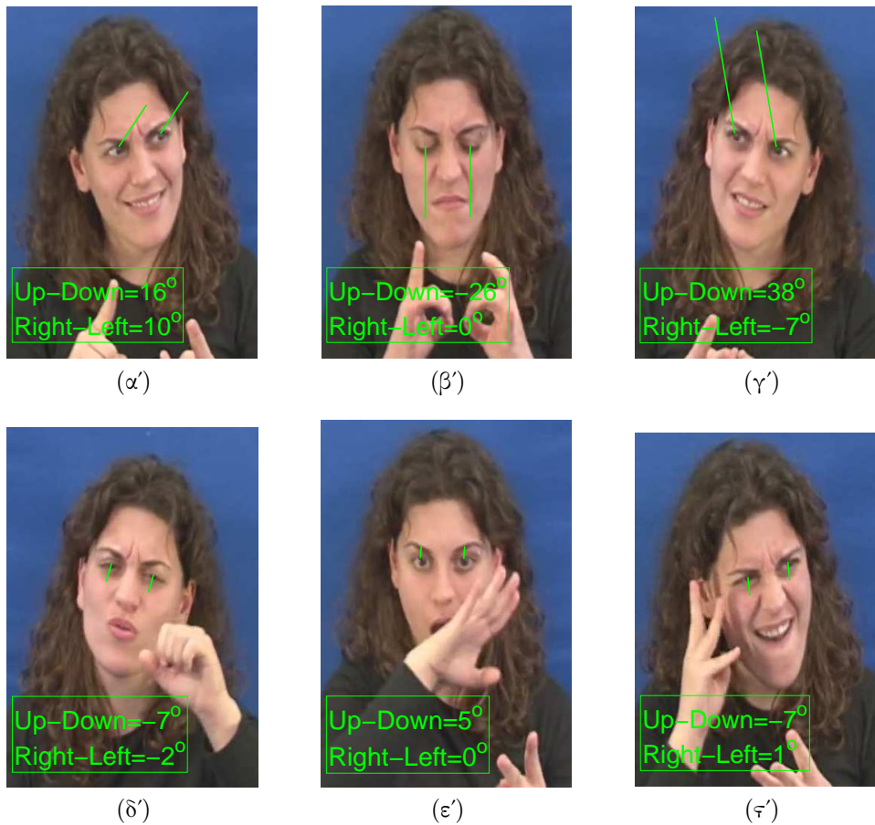
Σχήμα 5.6: Παραδείγματα εφαρμογής της μεθόδου υπολογισμού των γωνιών διεύθυνσης του gaze από τις πιθανοφάνειες των GMM κάθε κλάσης με χρήση των HOG χαρακτηριστικών, για τη βάση δεδομένων της ENΓ του IEL.
