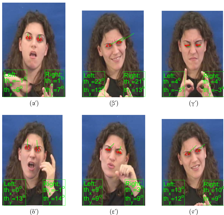
Σχήμα 4.14: Παραδείγματα εφαρμογής του γεωμετρικού μοντέλου εκτίμησης του eye gaze, χωρίς πληροφορία για την πόζα κεφαλιού, για τη βάση δεδομένων της ENΓ του IEL.
