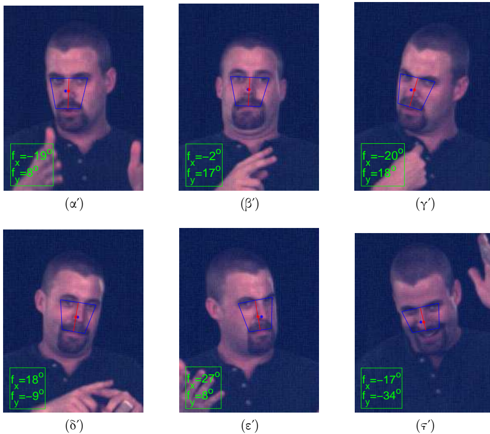
Σχήμα 4.9: Παραδείγματα εφαρμογής της μεθόδου υπολογισμού της πόζας κεφαλιού για τη βάση δεδομένων BU400.
