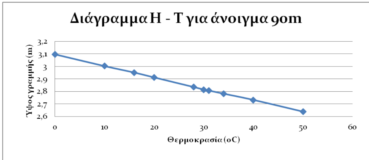
Σχήμα 23 : Διάγραμμα ύψους αγωγού – θερμοκρασίας για αγωγό διατομής 35 mm 2 , με βασικό άνοιγμα 150 m, άνοιγμα 90 m και μέση (κανονική) επιφόρτιση.
