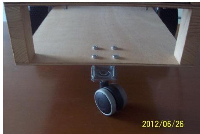
Εικόνα 3.2.5. Περιστρεφόμενος βοηθητικός τροχός – caster wheel .
