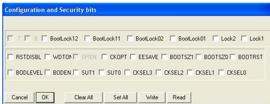
Εικόνα 4. Το παράθυρο ρύθμισης των Security και Configuration Bits.
