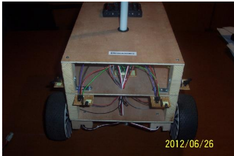
Εικόνα 3.2.6. Τοποθέτηση μπροστινών τροχών.
