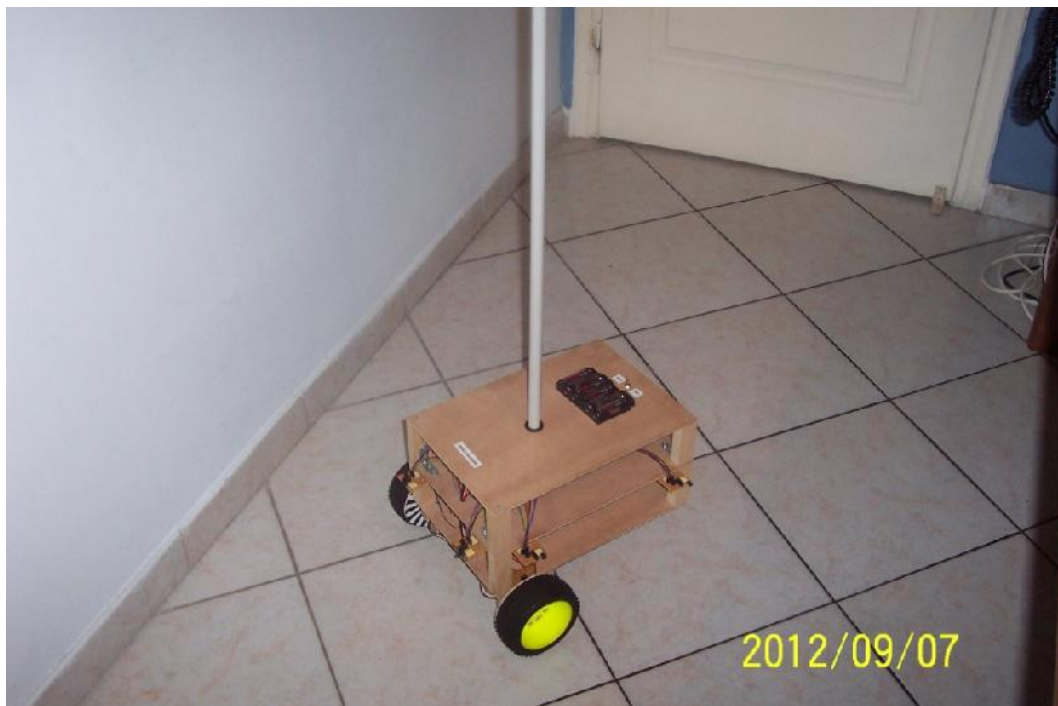
Εικόνα 3.2.9. Ο στύλος για την στήριξη του μικροφώνου εκτείνεται σε ύψος 1,20m.
