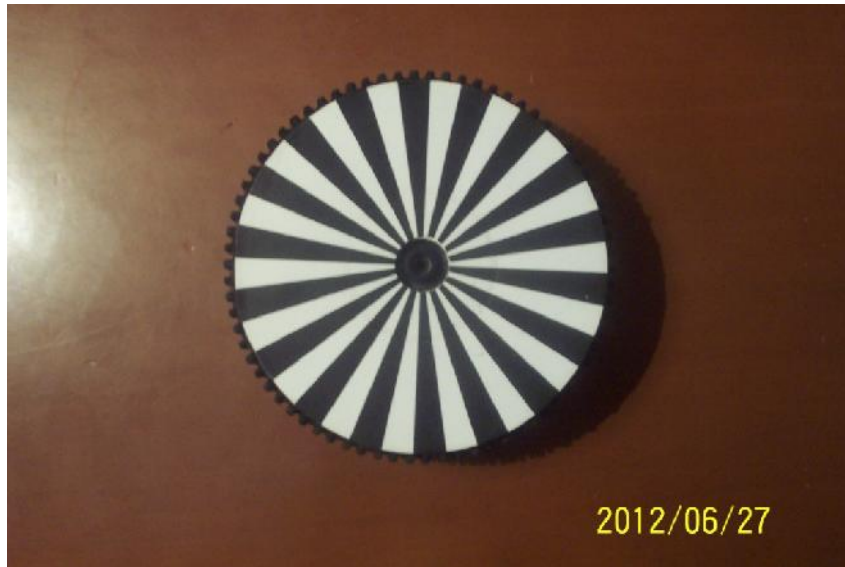
Εικόνα 3.5.1.1. Ο encoder disc προσαρμοσμένος πάνω στη ρόδα.
