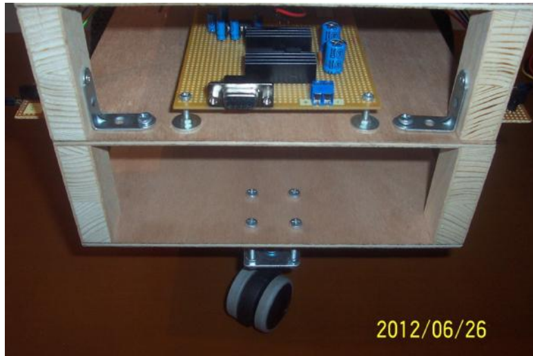
Εικόνες 3.2.3. και 3.2.4. Τρόπος διασύνδεσης του δεύτερου και του τρίτου επιπέδου της κατασκευής.
