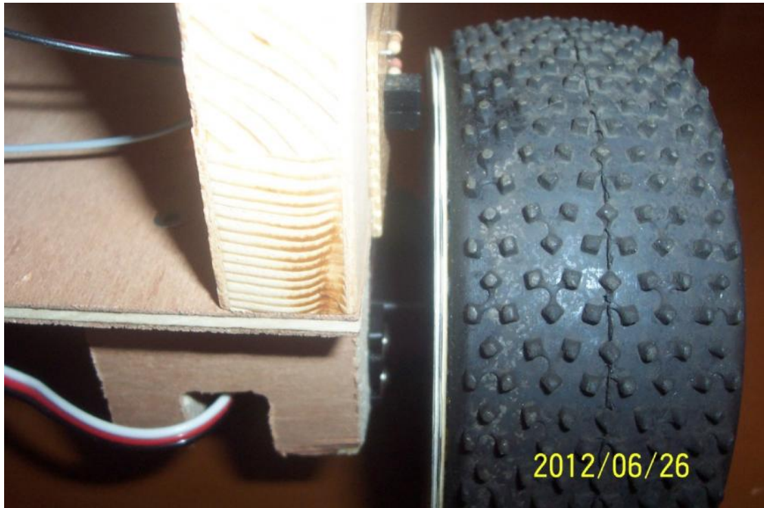
Εικόνα 3.5.3.3. Απόσταση του αισθητήρα από τον encoder disc.
