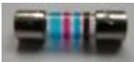
Εικόνα 16: Μικροσκοπική ασφάλεια 5 × 20 mm με κωδικό χρώμα
