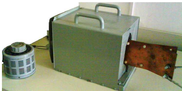
Εικόνα 30: Διάταξη αυτομετασχηματιστή μετασχηματιστή
