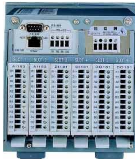
Εικόνα Π3 Η πίσω όψη του καταγραφικού, στην οποία διακρίνονται οι έξι κατάλληλα διαμορφωμένοι υποδοχείς των καρτών εισόδου, οι ίδιες οι κάρτες, καθώς και τα κανάλια εισόδου.
