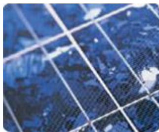
Σχ.2.5 : Πολυκρυσταλλικό πυρίτιο
