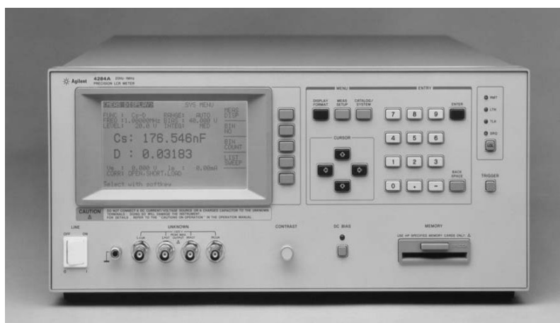
Σχ.6.1 Γέφυρα μέτρησης LCR
