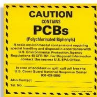
Σχ. 4.3 Απόσυρση μετασχηματιστών με PCB και η σχετική ετικέτα
