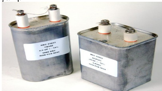
Σχ. 5.10 Πυκνωτές ελαίου 2 \mu F και 25 \mu F για φιλτράρισμα της dc συνιστώσας
