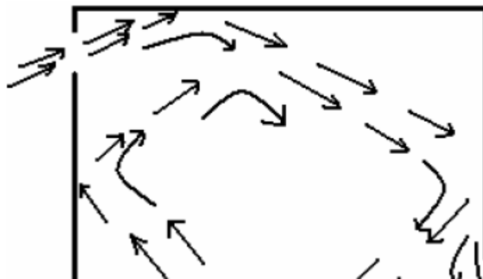
Σχήμα 2. 4 : Επιθυμητή ροή του ανέμου μέσα σε ένα κτίριο
