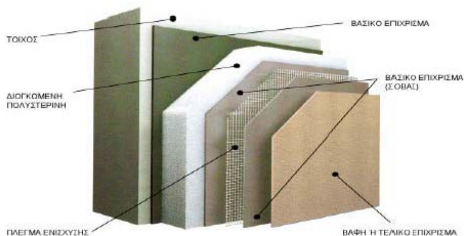
Σχήμα 2.6 : Τομή στρώσεων θερμομονωτικού υλικού
