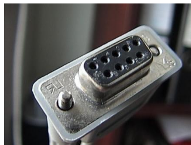
Σχήμα Π-3. DB9 υποδοχή, αρσενική (αριστερά) και θηλυκιά (δεξιά).
