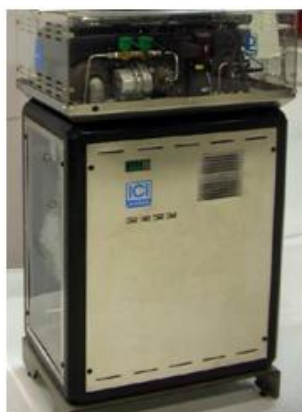
Εικόνα 2.5. Κυψέλη καυσίμου Mira 6 και αντιστροφέας τάσης DELTA DHF-1AC-5000W.
