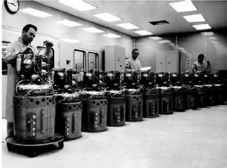
Εικόνα 3.3. Συναρμολόγηση των συστημάτων κυψελών καυσίμου του Apollo.
