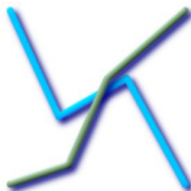
Σχήμα 5.5: Η κλασική περίπτωση όπου η ST_Crosses επιστρέφει TRUE. Εικόνα από το documentation της PostGIS
