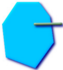
Σχήμα 5.4: Μία περίπτωση όπου η ST_Contains επιστρέφει FALSE. Εικόνα από το documentation της PostGIS
