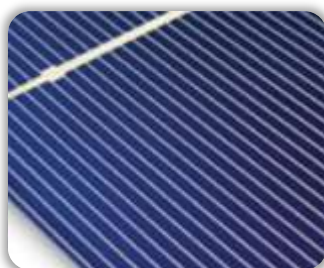
Εικόνα 2.4 «Κύτταρο Μονοκρυσταλλικού Πυριτίου»
