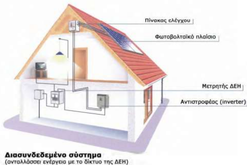
Εικόνα 2.9 «Διασυνδεδεμένο οικιακό σύστημα Φ/Β»
