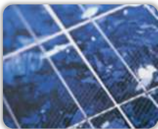
Εικόνα 2.5 «Κύτταρο Πολυκρυσταλλικού Πυριτίου»
