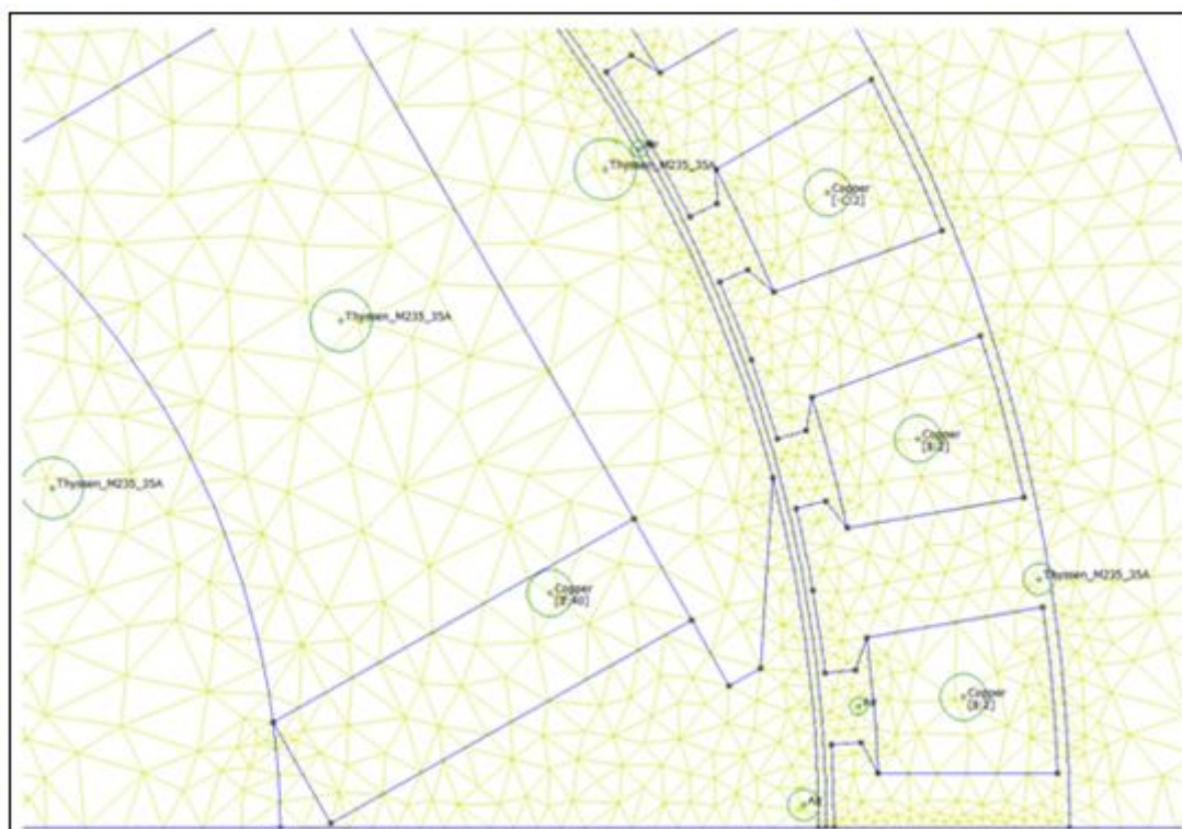
Σχήμα 4.1: Πλέγμα σύγχρονης γεννήτριας έκτυπων πόλων.
