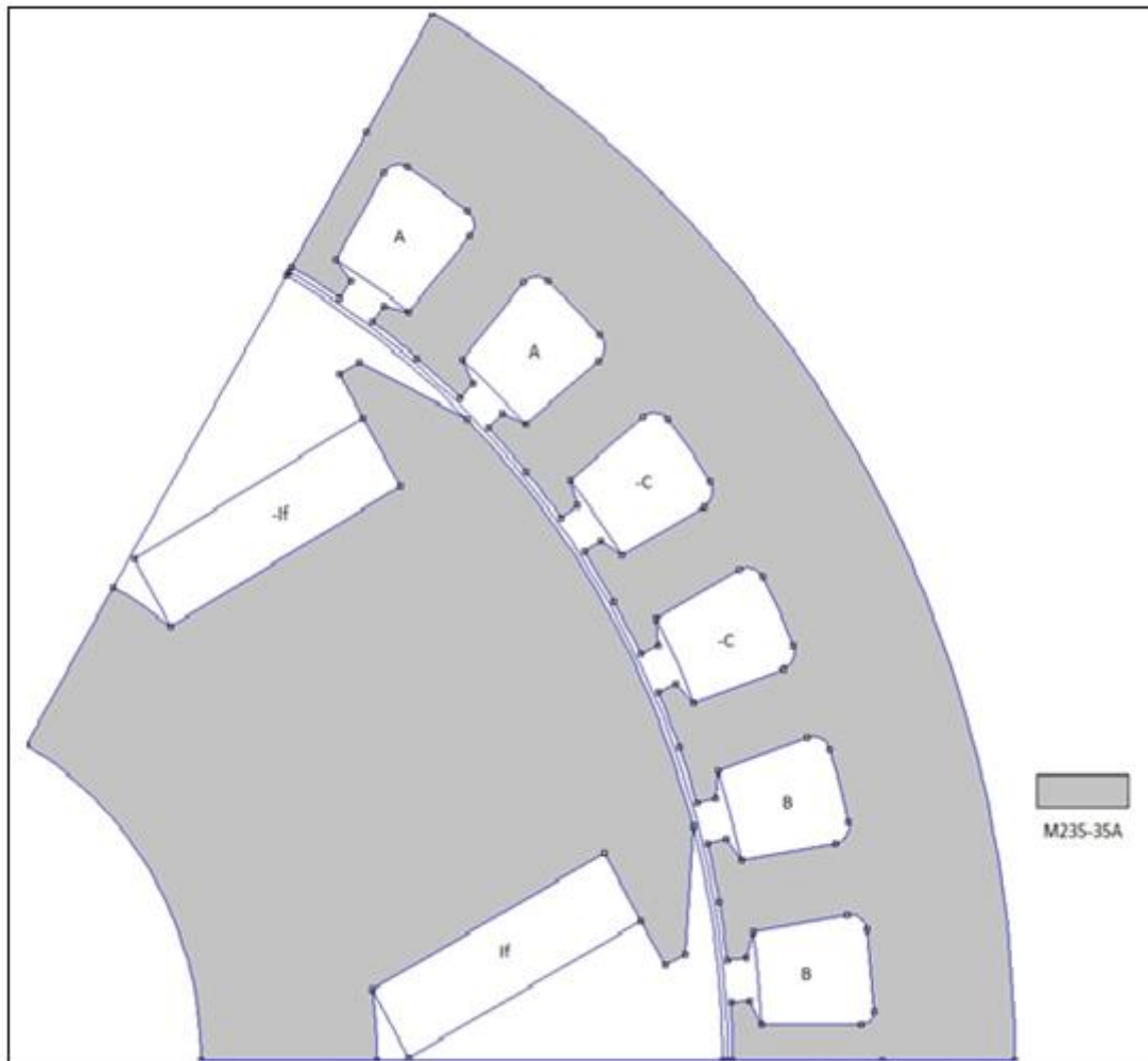
Σχήμα 4.14: Τελική διαμόρφωση γεννήτριας έκτυπων πόλων.
