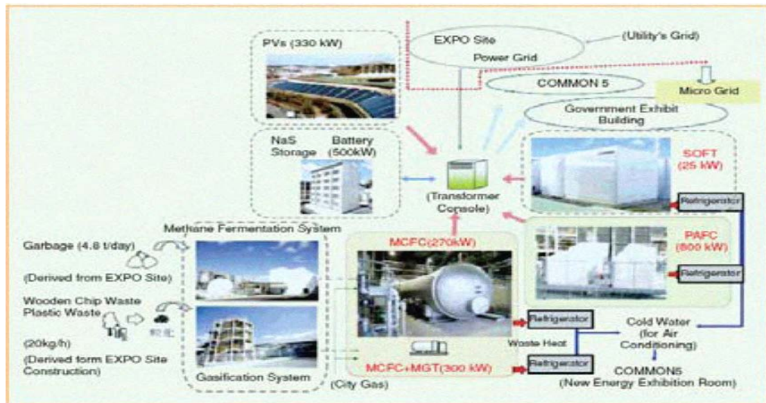
Εικόνα 4.3: Διάγραμμα του μικροδικτύου στο Aichi
