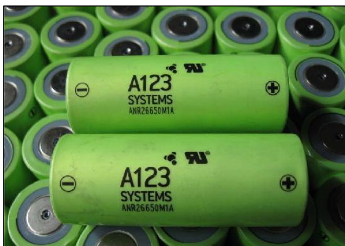
Σχήμα 4.57 – Πηγή Ισχύος του ηλεκτρικού συστήματος κίνησης αποτέλεσαν οι μπαταρίες τεχνολογίας LiFePO 4
