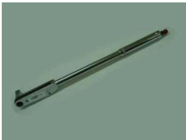
Σχήμα 3.2-2: Το ροπόκλειδο, εργαλείο με το οποίο καθορίστηκε η τιμή της ροπής σύσφιξης στους κοχλίες του συνδέσμου
