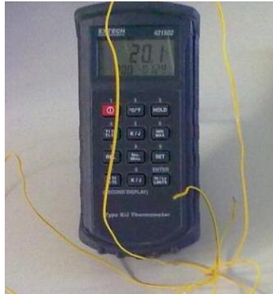
Σχήμα 3.1.5-1: Θερμοστοιχείο σιδήρου – κονσταντάνης
