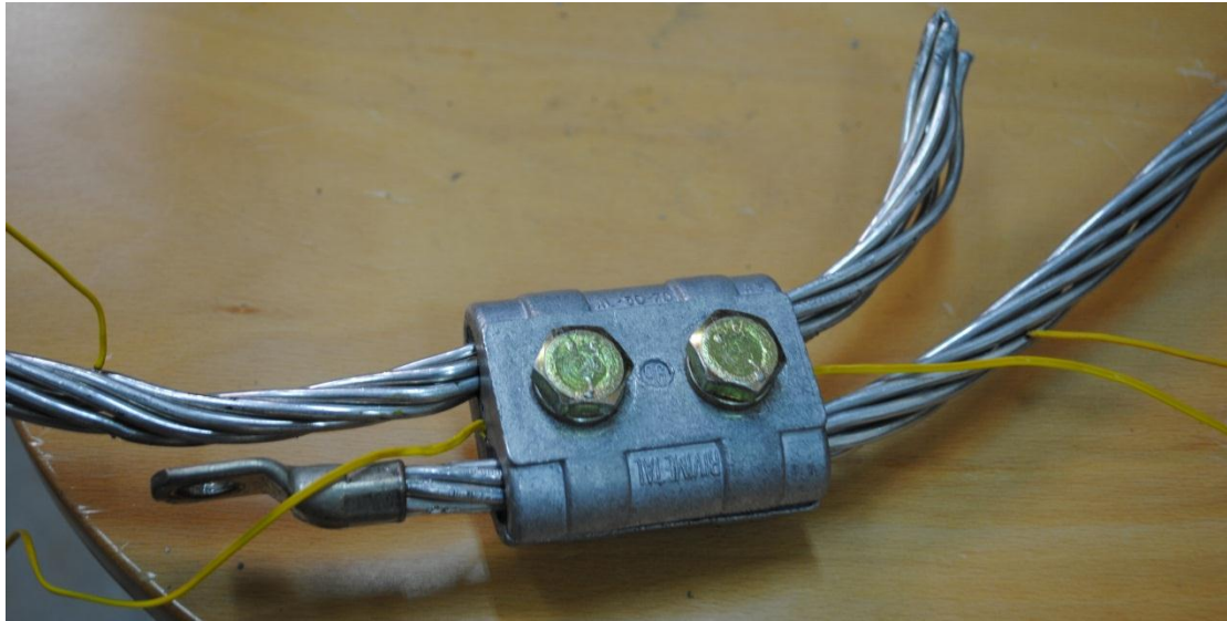
Σχήμα 3.2-3: Φωτογραφία της διάταξης μέτρησης της θερμοκρασίας
