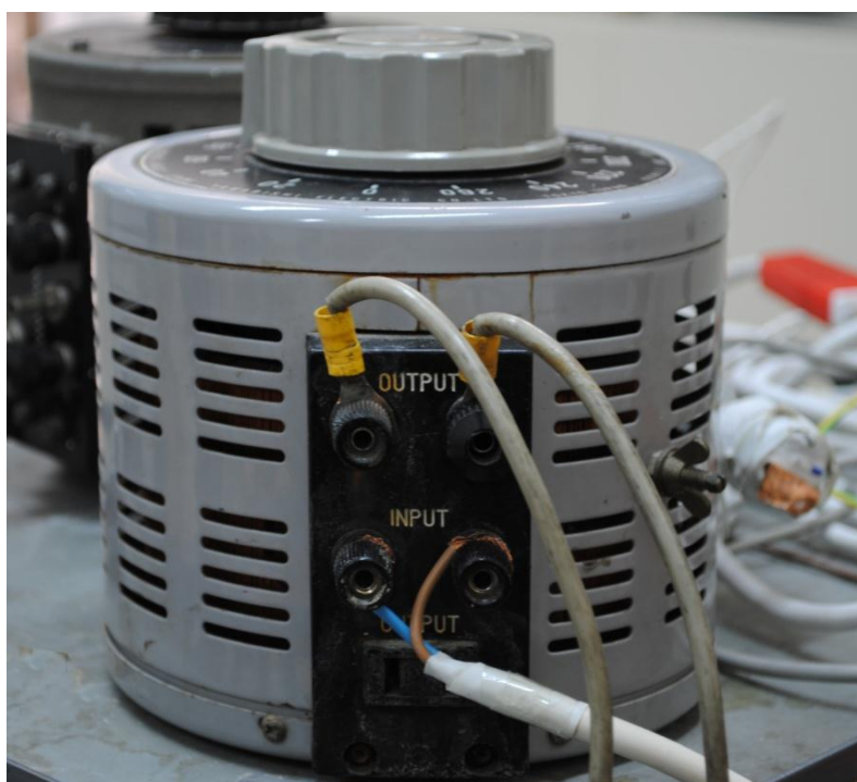
Σχήμα 3.1.1-1: φωτογραφία του αυτομετασχηματιστή ενδιάμεσης λήψης (VARIAC)
