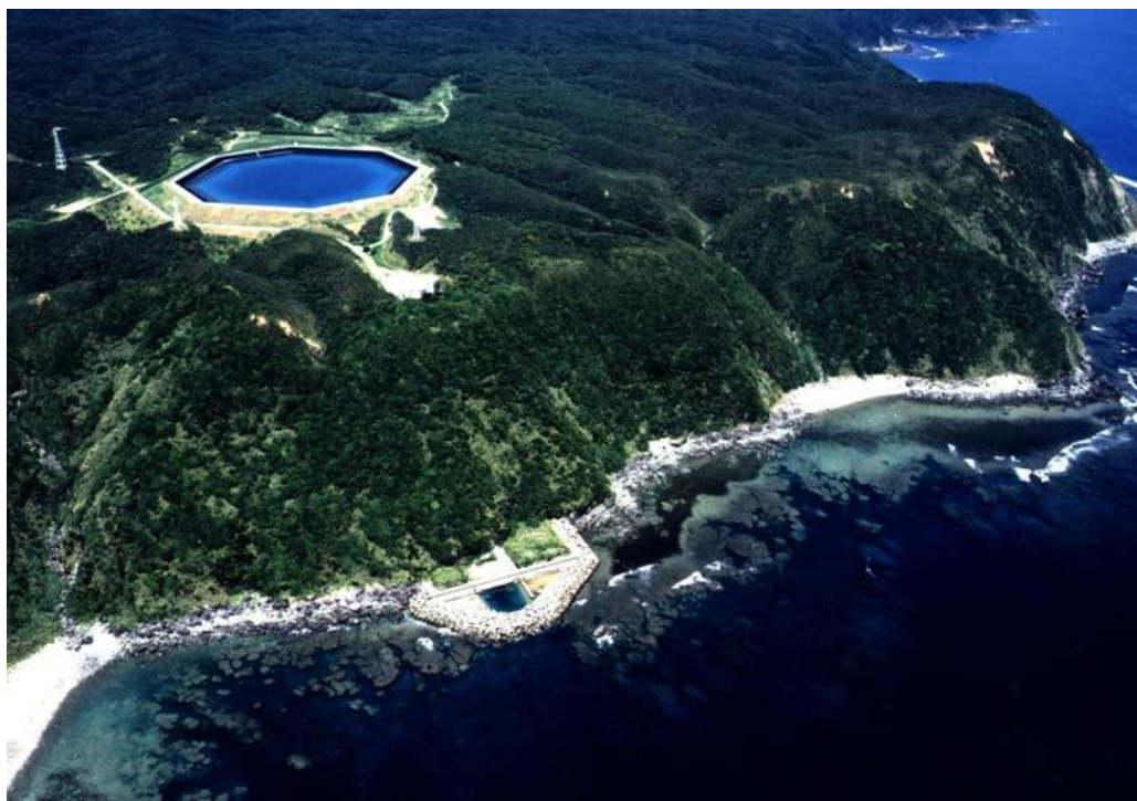
Σχήμα 2. 5 Εφαρμογή συστήματος αντλησιοταμίευσης με κάτω ταμιευτήρα τη θάλασσα
