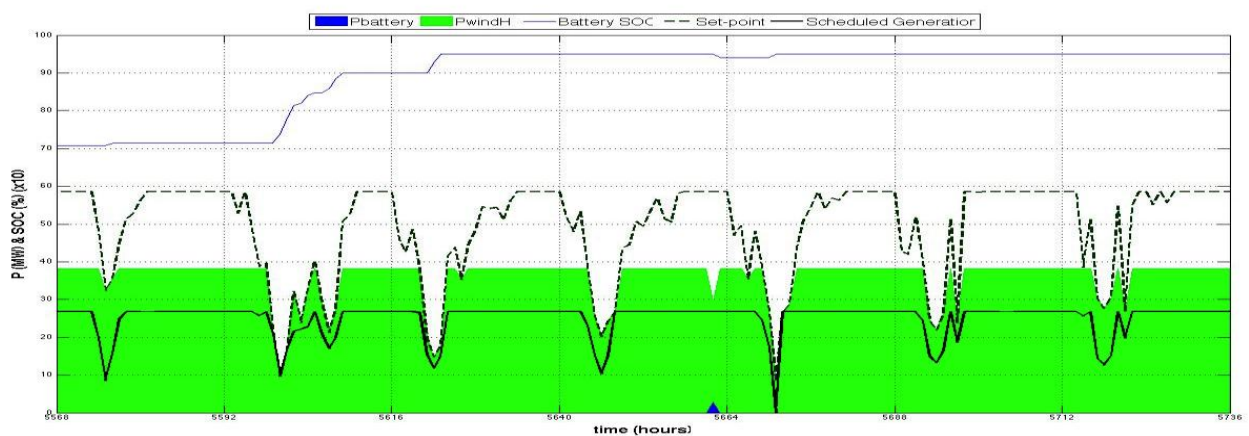
(α) Παραγωγή Μπαταριών, έγχυση αιολικής ισχύος στο δίκτυο μέσω υποκατάστασης ισχύος των μπαταριών ή αξιοποίησης περισσεύς setpoint και SoC μπαταριών
