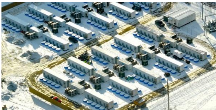
Σχήμα 2.7 Εφαρμογή ενός ESS με σφονδύλους από την Beacon Power ( http://www.cleanenergyactionproject.com/CleanEnergyActionProject/CS.Beacon_Power_Stephentown_Advanced_Energy_Storage_Energy_Storage_Case_Study.html )
