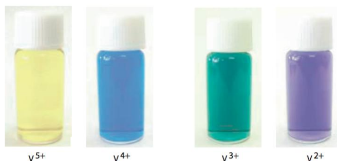
Σχήμα 3.6 Χρώμα των διαλυμάτων διαφορετικών ιόντων βαναδίου
