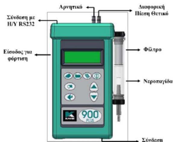
Εικόνα 4.31: Αναλυτής καυσαερίων KANE 900 PLUS
