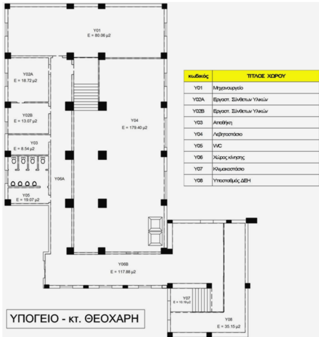
Σχήμα 4.5: Κάτοψη υπογείου και αρίθμηση χώρων
