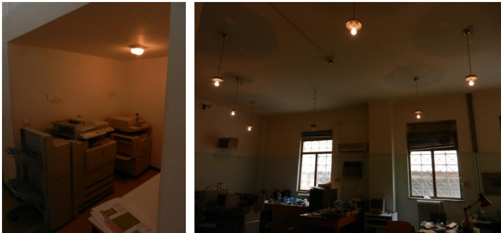
Σχήμα 4.14: Υποδιαστασιολόγηση φωτιστικών και ανεπαρκής φωτισμός
