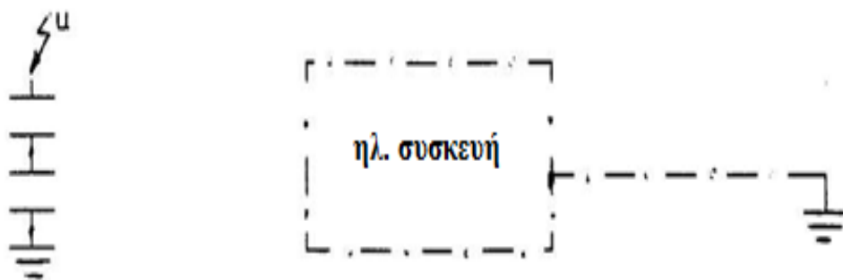
Σχήμα 2.2.1.1 : (α) γείωση λειτουργίας, (β) γείωσης προστασίας
