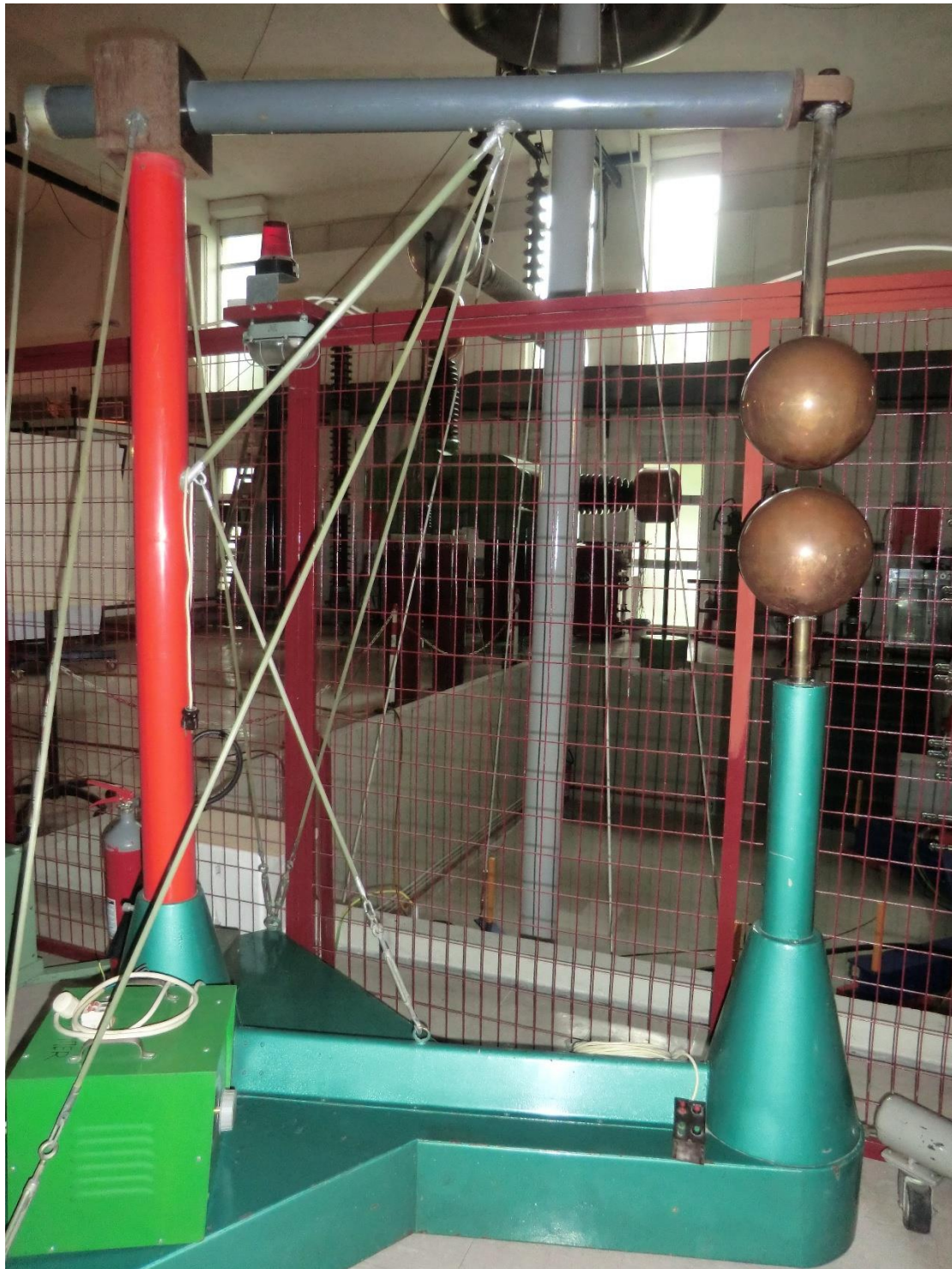
Σχήμα 8.21: Σπινθηριστής σφαιρών για μέτρηση υψηλών τάσεων
