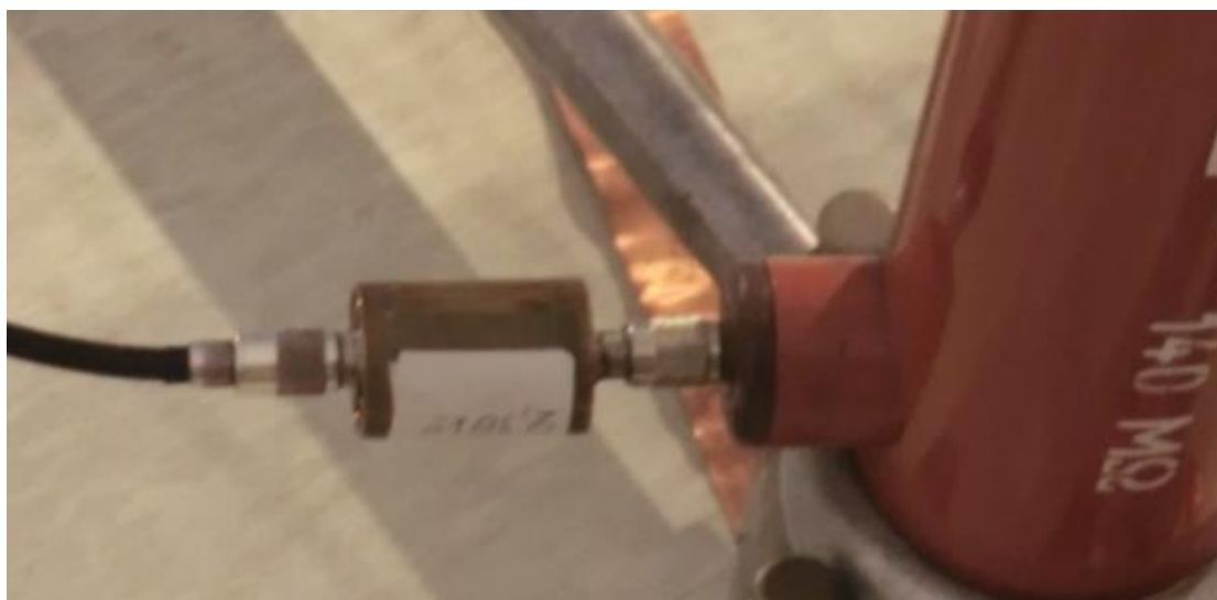
Εικόνα 8.14: Ωμικός καταμεριστής για υποβιβασμό της υψηλής τάσης. Στην αντίσταση μέτρησης R_M=140M\Omega συνδέεται εν σειρά μια μικρή αντίσταση r=3,27k\Omega , οπότε σχηματίζεται ωμικός καταμεριστής που συνδέεται μέσω ομοαξονικού καλωδίου στο όργανο καταγραφής
