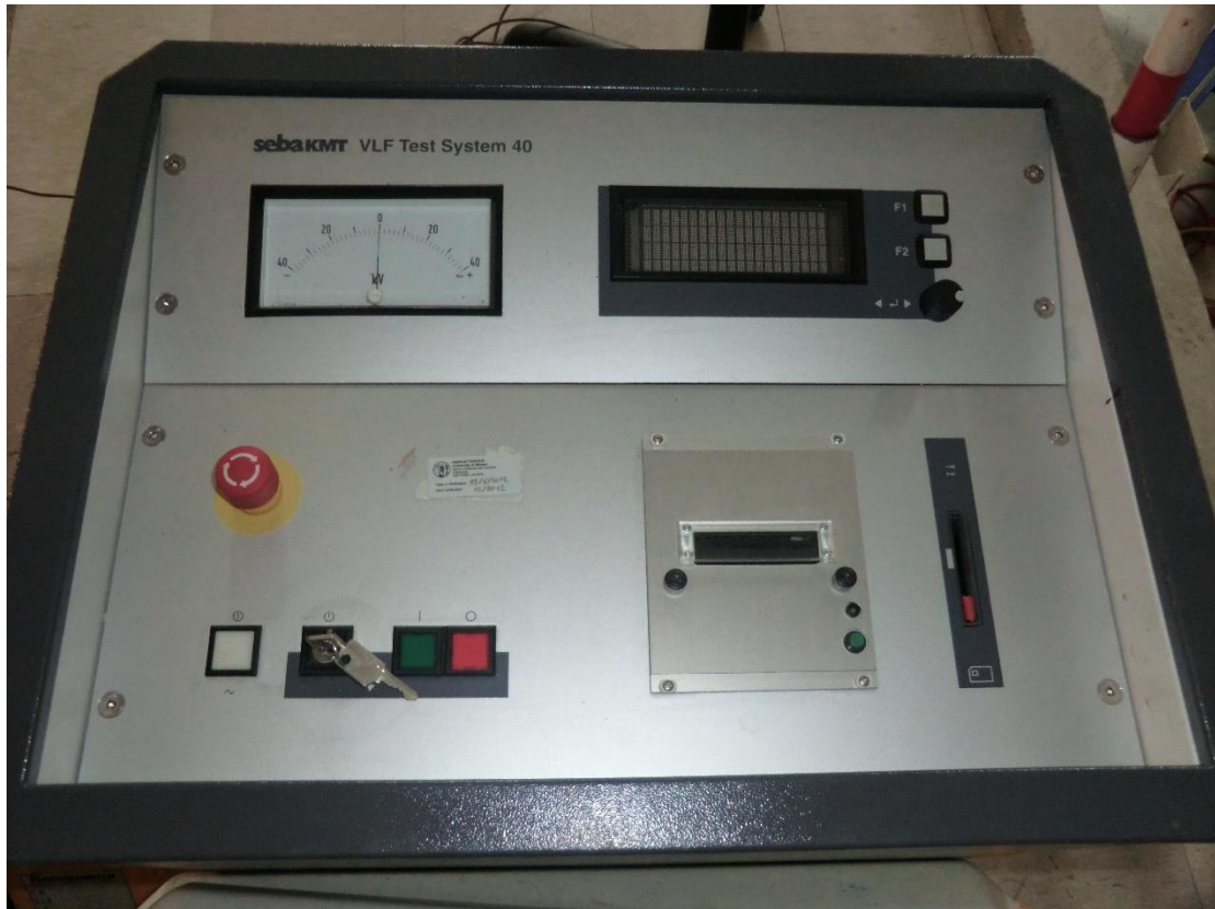
Σχήμα 8.22: Συσκευή SEBA KMT VLF Test System 40 για τον έλεγχο της διηλεκτρικής αντοχής της μόνωσης καλωδίων, με εφαρμογή υψηλής τάσης πολύ χαμηλής συχνότητας
