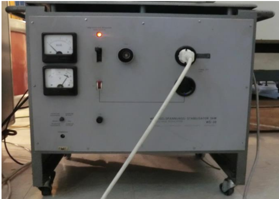
Εικόνα 8.6: Σταθεροποιητής Wechselspannungs-Stabilisator 3kW, WS-30, ο οποίος δίνει τάση από την τροφοδοσία του δικτύου στην τράπεζα χειρισμών και μειώνει τις διακυμάνσεις της τάσης του δικτύου εξασφαλίζοντας ότι για τη μεταβολή της τάσης του δικτύου εντός των ορίων 230 \pm 10\% V η τάση στην έξοδό του θα έχει μικρή διακύμανση 230V \pm 0,5\% V (μεταξύ 228,9 και 231,1V)
