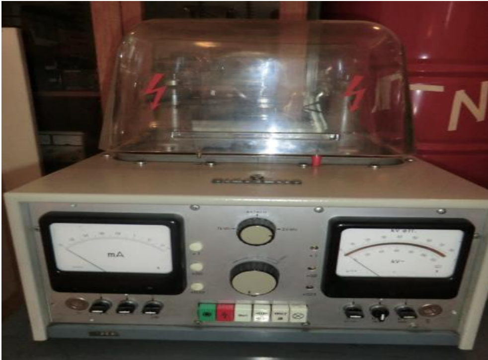
Σχήμα 8.18: Συσκευή SIEMENS για τον έλεγχο της διηλεκτρικής αντοχής μονωτικού λαδιού
