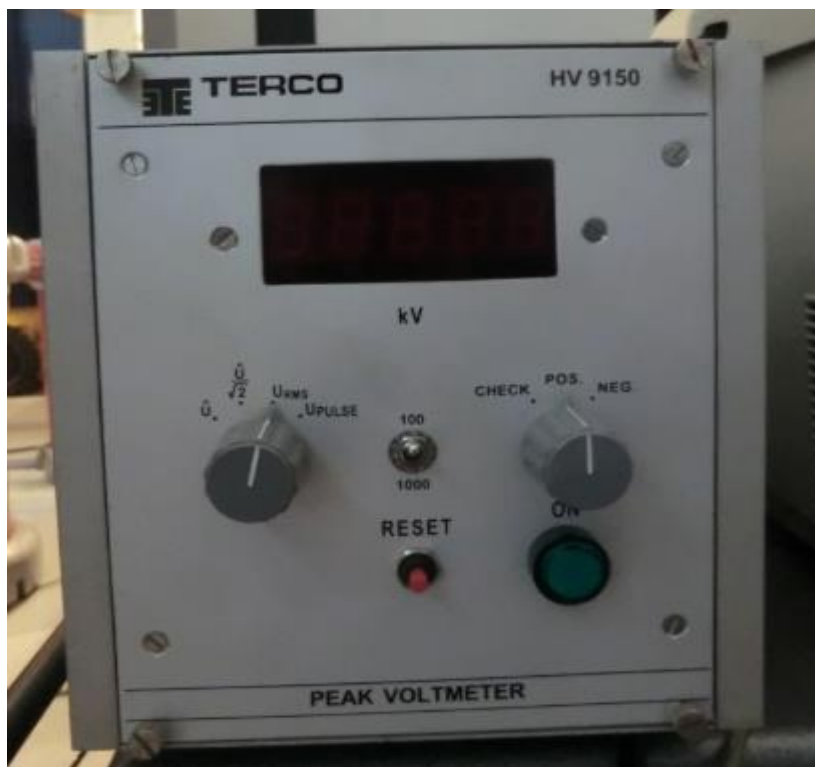
Σχήμα 8.9: Βολτόμετρο μεγίστου (SM), TERCO HV9150 PEAK VOLTMETER
