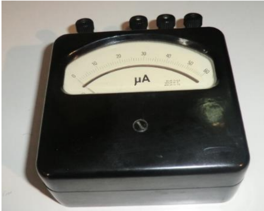
Σχήμα 8.11: Μικρο-αμπερόμετρο κινητού πηνίου, μετρά τη μέση τιμή του ρεύματος
