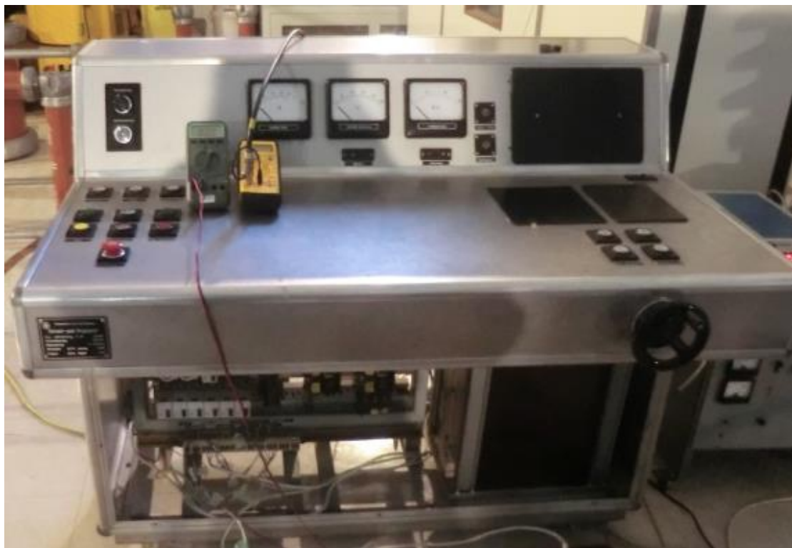
Σχήμα 8.7: Τράπεζα Χειρισμών / Αυτομετασχηματιστής με μεταβλητή λήψη ώστε η τάση να κυμαίνεται από 0-230V
