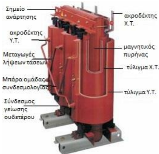
Σχήμα 5.9: Μετασχηματιστής ξηρού τύπου
