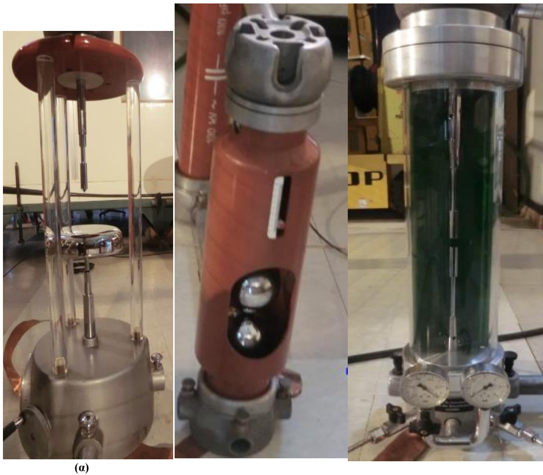
Σχήμα 8.13: Διάκενα με διάταξη ηλεκτροδίων (α) ακίδα-πλάκα, (β) σφαίρα-σφαίρα, (γ) πλάκα-πλάκα
