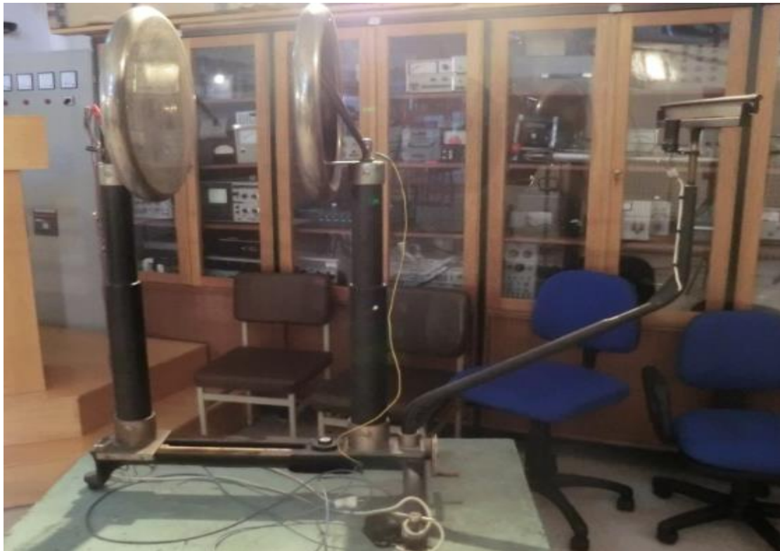
Εικόνα 8.12: Ηλεκτροστατικό βολτόμετρο για τη μέτρηση και των τριών μορφών υψηλών τάσεων
