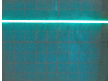
Σχήμα 3.18: Συνεχής τάση εξόδου ποτενσιόμετρου ακριβείας.
