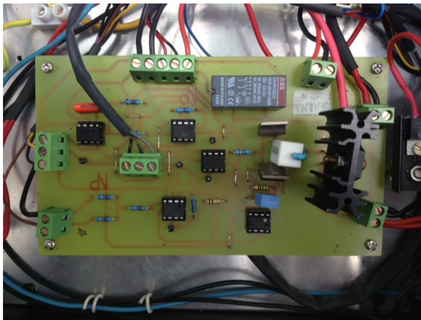
Σχήμα 3.16: Κύκλωμα ελέγχου του διακοπτικού στοιχείου.
