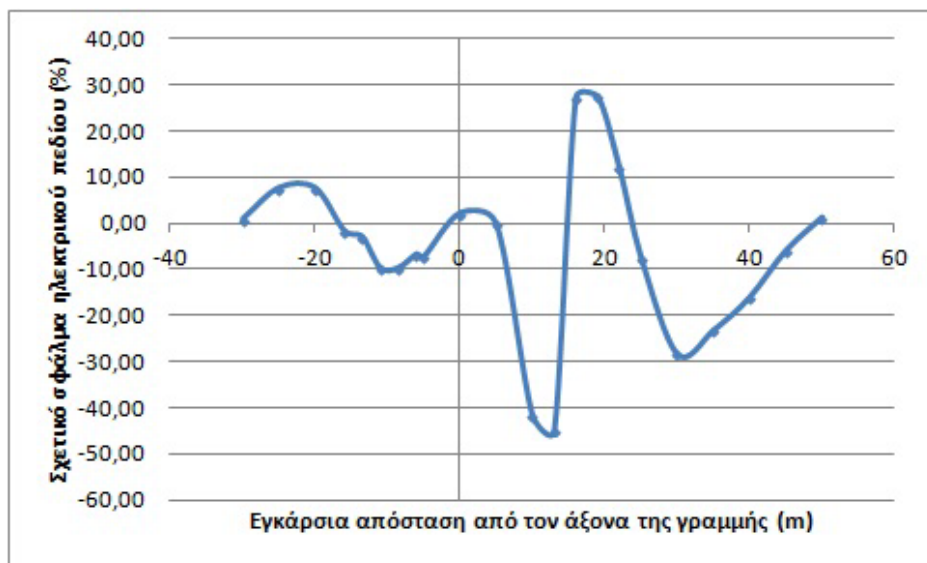
Σχήμα 5.37: Σχετικό σφάλμα (%) μεταξύ μετρούμενων και υπολογισμένων τιμών ηλεκτρικού πεδίου.
