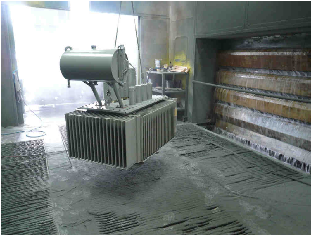
Εικόνα 3.40 - Τελική βαφή με ψεκασμό του Μ/Σ εντός καμπίνας βαφής με σύστημα απομάκρυνσης των αναθυμιάσεων και των καταλοίπων βαφής μέσω καταρράκτη νερού
