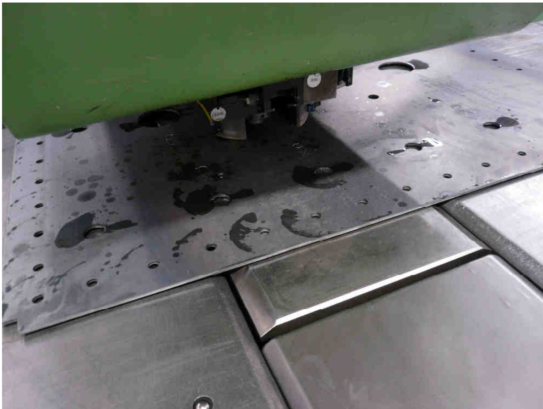
Εικόνα 3.14 – Στάδιο διάτρησης και κοπής καλύμματος Μ/Σ με χρήση πρέσας CNC
