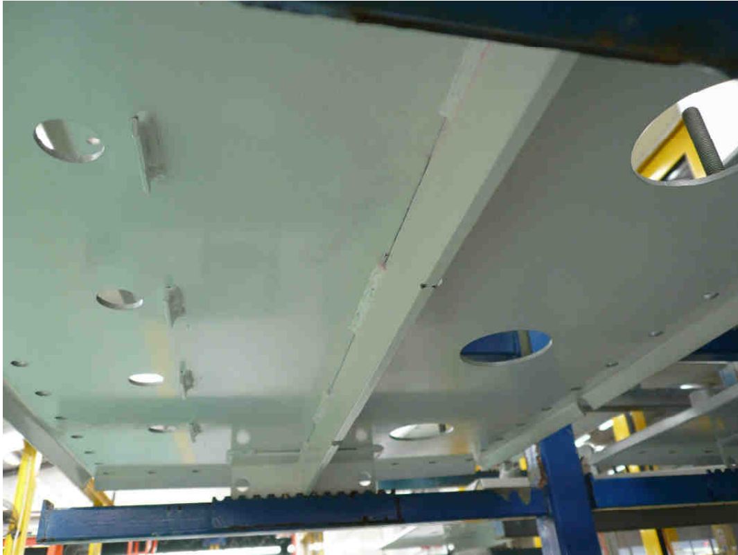
Εικόνα 3.17 - Κάτω πλευρά καλύμματος όπου διακρίνονται τα στηρίγματα-ενισχύσεις
