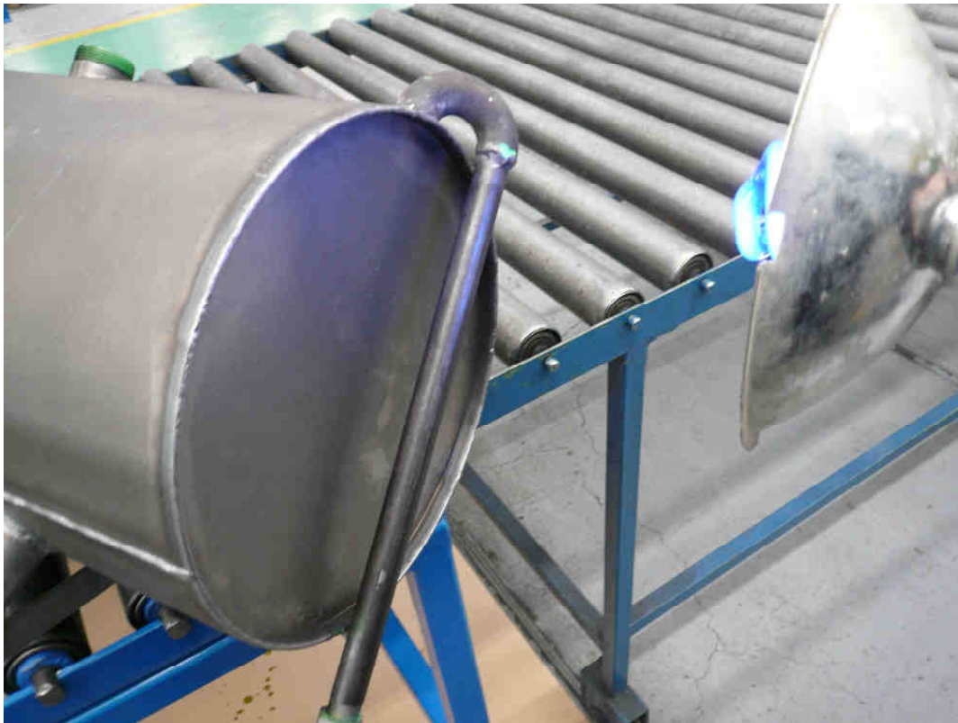
Εικόνα 3.19 - Έλεγχος στεγανότητας σε δοχείο διαστολής
