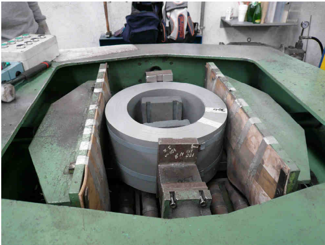
Εικόνα.3.28 - Πρέσα για την τελική διαμόρφωση σκέλους πυρήνα (πριν την διαμόρφωση)
