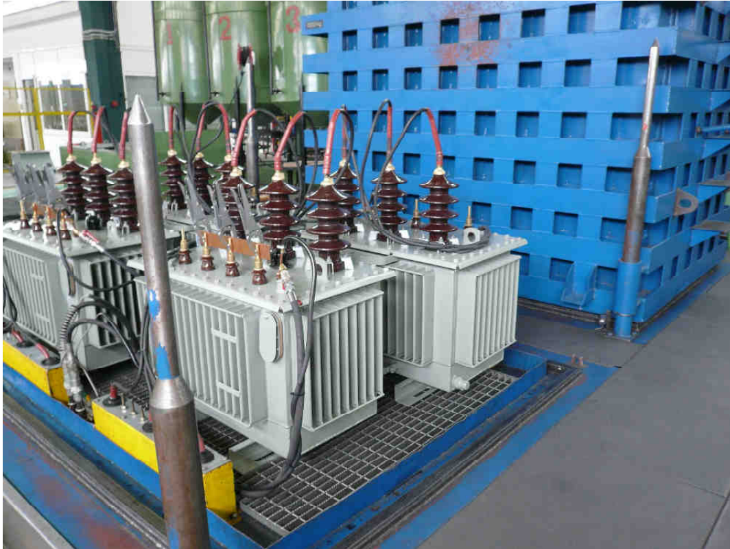
Εικόνα 3.38 - 2 ος θάλαμος ξήρανσης (μέθοδος ηλεκτρικής ξήρανσης) και κενού
