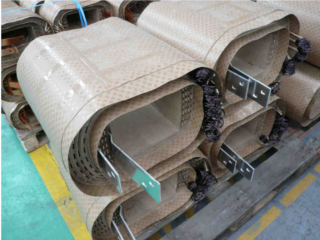
Εικόνα.3.25 - Πηνία (για Μ/Σ 630 kVA, 0.4/20 kV) έτοιμα για συναρμολόγηση με τον πυρήνα
