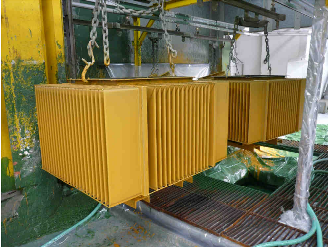
Εικόνα 3.11 - Αστάρωμα (1 η στρώση) για την προστασία κατά της οξείδωσης των εξωτερικών επιφανειών της δεξαμενής και του καλύμματος
