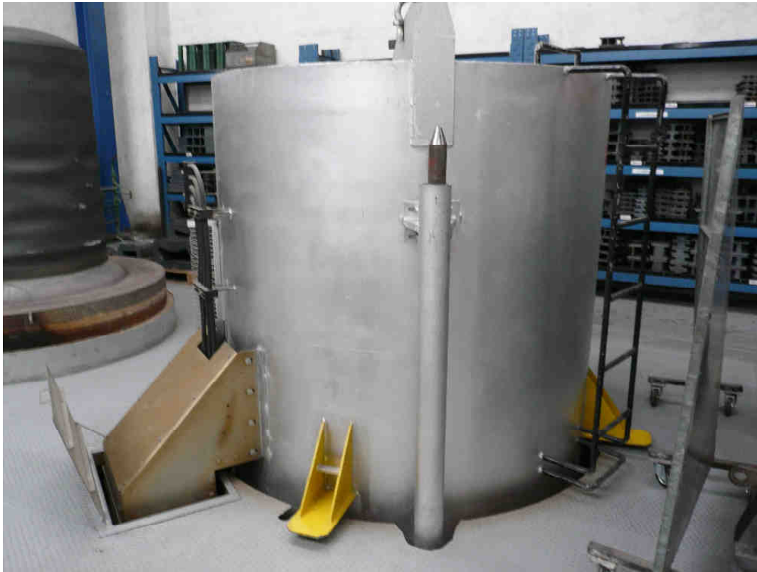
Εικόνα.3.31 - Θάλαμος μέσα στον οποίο λαμβάνει χώρα η διαδικασία της ανόπτησης 1
