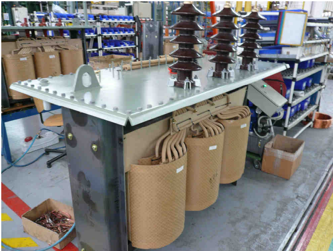
Εικόνα 3.36 - Κατασκευή ενεργού μέρους Μ/Σ 2500 kVA, 33/11 kV (πλευρά μέσης τάσης)
