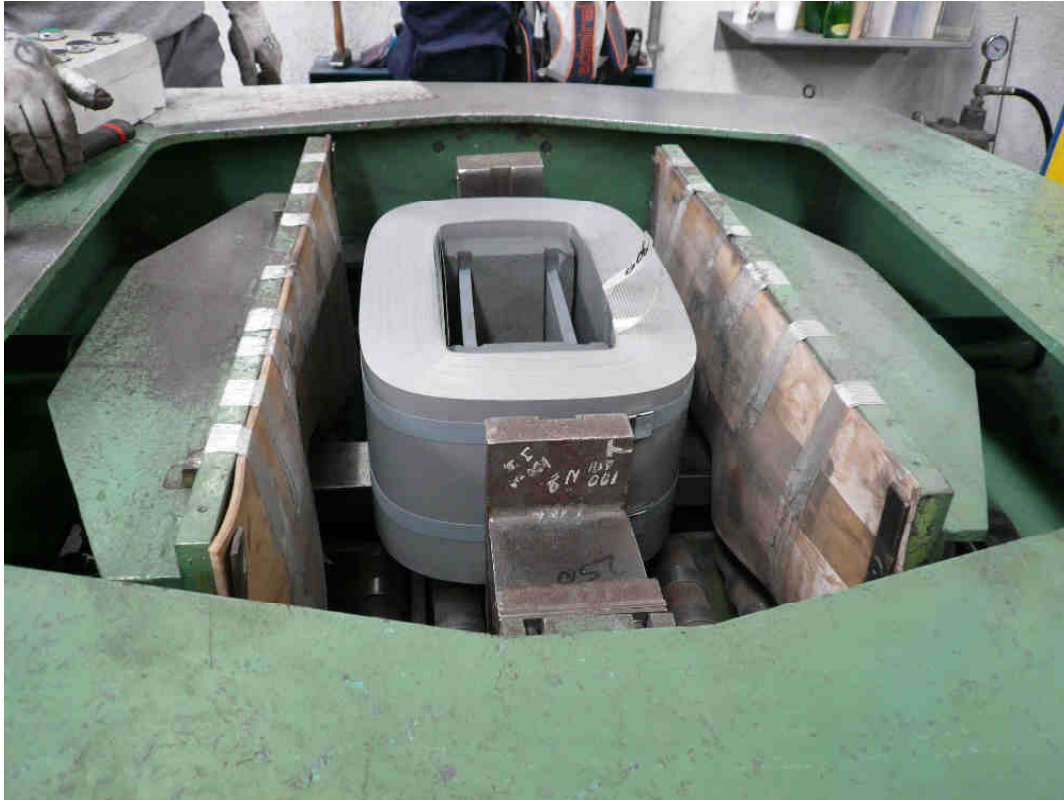
Εικόνα.3.29 - Πρέσα για την τελική διαμόρφωση σκέλους πυρήνα (μετά την διαμόρφωση)
