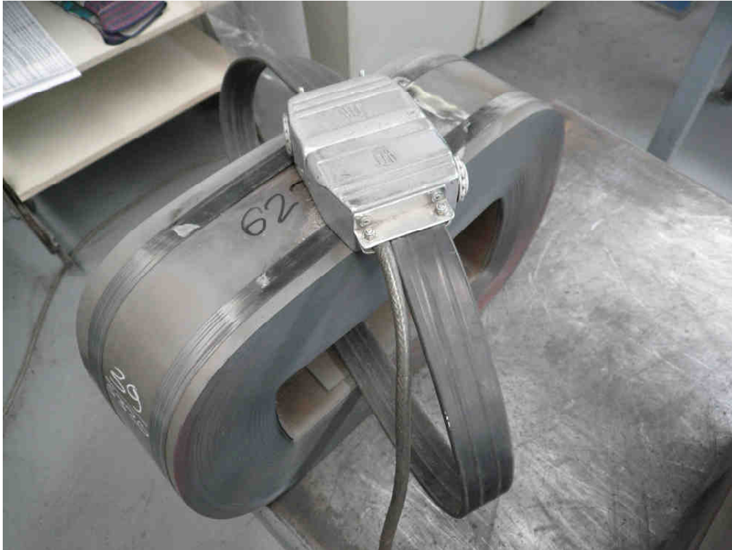
Εικόνα.3.32 - Πηνίο-ζώνη για τη μέτρηση των μονοφασικών απωλειών σκέλους πυρήνα προκειμένου να επιτευχθεί η βέλτιστη ομαδοποίηση των πυρήνων
