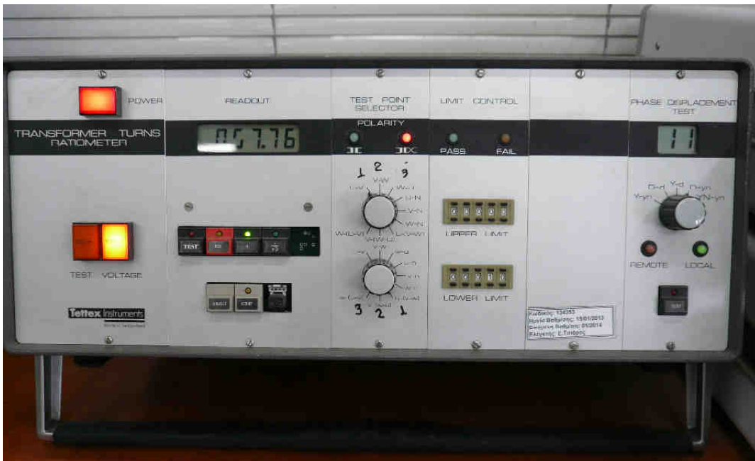
Εικόνα 3.45 – Όργανο μέτρησης του λόγου μετασχηματισμού και της ομάδας συνδεσμολογίας
