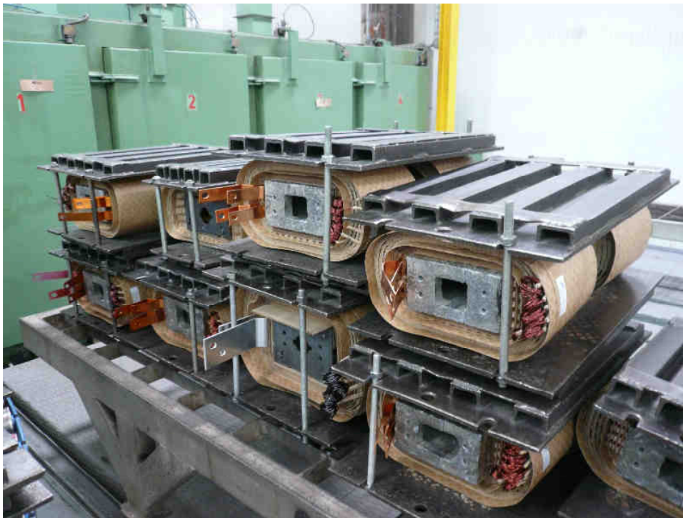
Εικόνα.3.24 - Πρεσαρισμένα πηνία πριν τη τοποθέτησή τους σε θαλάμους ξήρανσης για την απομάκρυνση της υπάρχουσας υγρασίας αλλά και για το “δέσιμο” του τυλίγματος με το χαρτί της εποξικής ρητίνης
