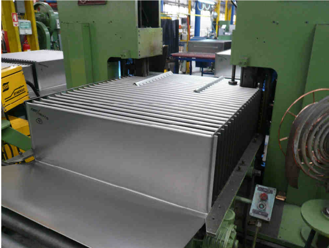
Εικόνα 3.3 - Διαμορφωμένοι χάλυβες κατά τη διάρκεια κόλλησης της άνω και κάτω ραφής του κάθε πανέλλου ξεχωριστά
