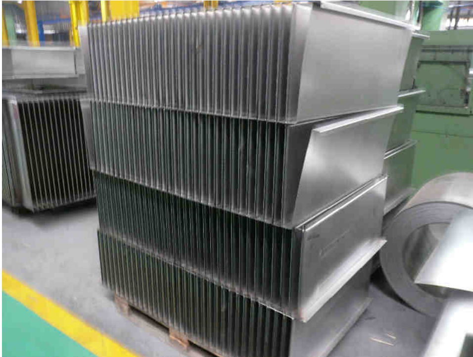
Εικόνα 3.5 - Διαμορφωμένοι χάλυβες (προοριζόμενοι για Μ/Σ 1600 kVA) προτού γίνει η συγκόλληση τους ώστε να αποτελέσουν τα πλευρικά τοιχώματα του Μ/Σ
