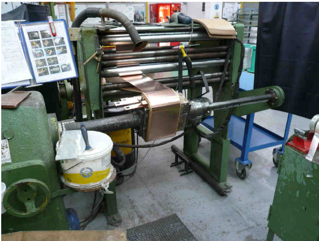
Εικόνα 3.20 - Περιελικτική μηχανή κατασκευής του πηνίου χαμηλής τάσης
