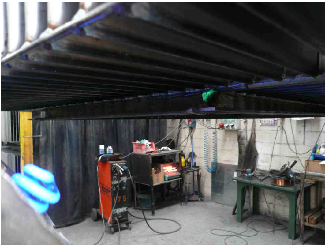
Εικόνα 3.6 - Μετά την ολοκλήρωση των κολλήσεων της δεξαμενής πραγματοποιείται έλεγχος στεγανότητας. Με τη βοήθεια UV ακτινοβολίας και του διεισδυτικού υγρού που πρώτα τοποθετείται στο εσωτερικό της δεξαμενής διαπιστώνεται ενδεχόμενη ύπαρξη οπής και συνεπώς μελλοντικής διαρροής.
