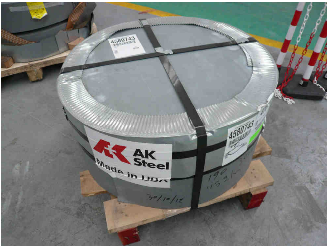
Εικόνα.3.26 - Χάλυβας (πρώτη ύλη) που θα χρησιμοποιηθεί για την κατασκευή του πυρήνα
