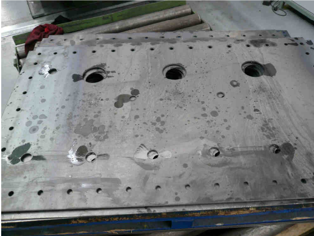
Εικόνα 3.15 - Κάλυμμα μετά την διάτρηση. Διακρίνονται οι οπές στις οποίες θα τοποθετηθούν εν τέλει οι μονωτήρες διέλευσης τόσο της χαμηλής όσο και της υψηλής τάσης.
