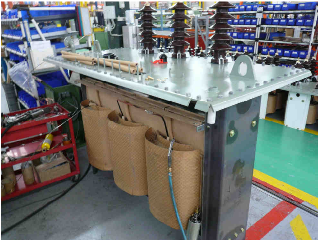
Εικόνα 3.35 - Κατασκευή ενεργού μέρους Μ/Σ 2500 kVA, 33/11 kV (πλευρά χαμηλής τάσης)
