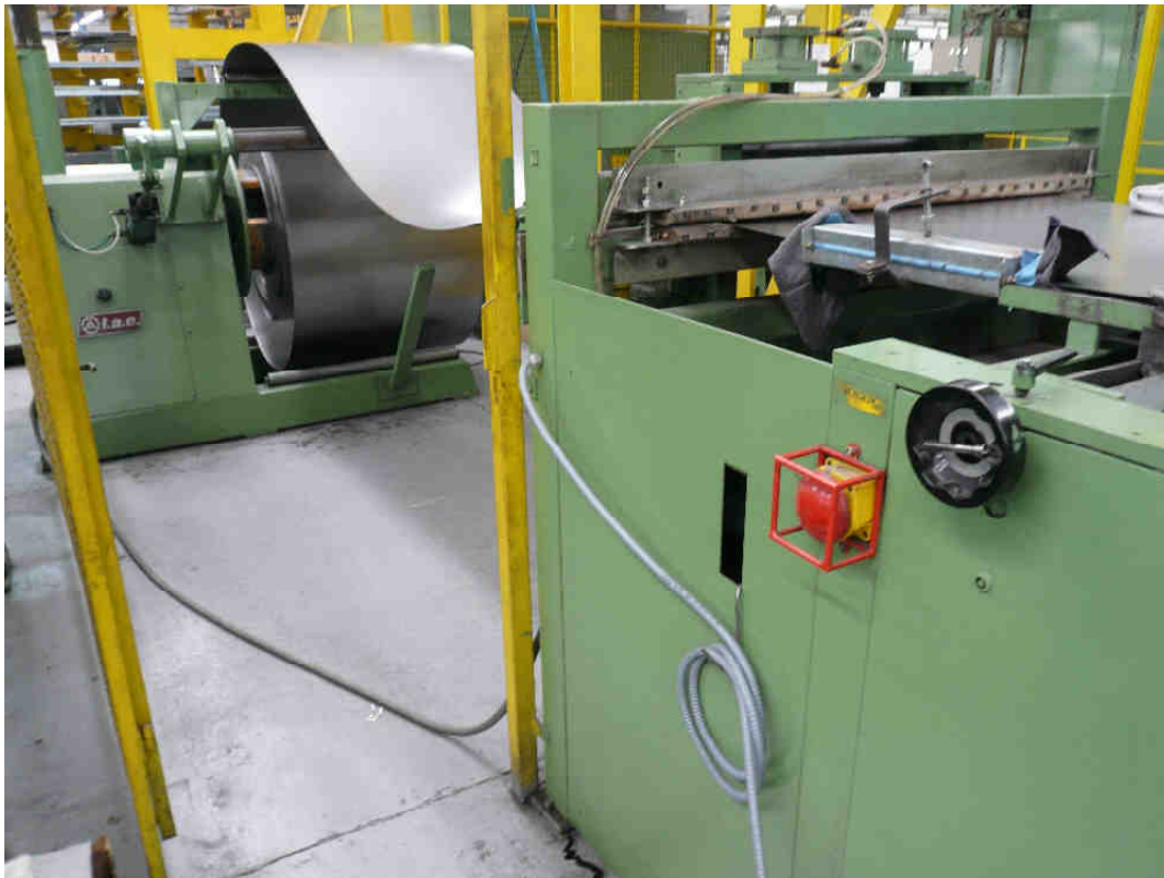
Εικόνα 3.1- Πρέσα διαμόρφωσης πλευρικών τοιχωμάτων (πανέλλων). Διακρίνεται η είσοδος του φύλλου στη πρέσα
