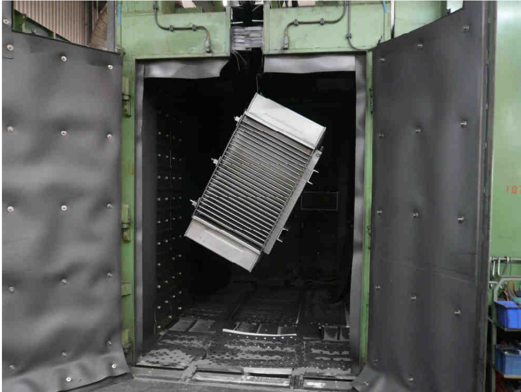
Εικόνα 3.9 - Θάλαμος αμμοβολής για την απομάκρυνση από δεξαμενές και καλύμματα των οξειδίων του σιδήρου και των υπολοίπων των συγκολλήσεων
