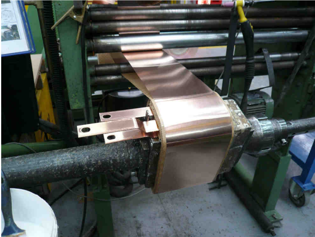
Εικόνα 3.21 - Στάδιο κατασκευής της περιέλιξης του πηνίου χαμηλής τάσης (για Μ/Σ 100 kVA)
