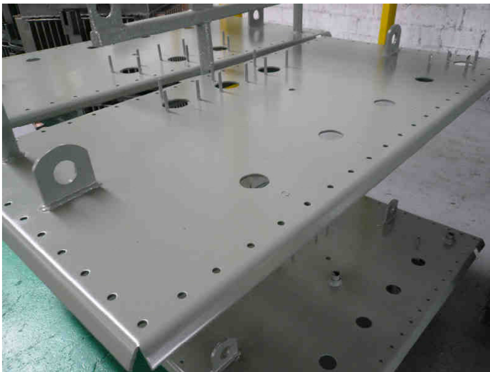
Εικόνα 3.16 - Κάλυμμα (για Μ/Σ 500 kVA) μετά και την βαφή του. Διακρίνονται οι λαβές ανάρτησης, οι οπές για τους μονωτήρες διέλευσης και οι περιμετρικές οπές για τα μπουλόνια συγκράτησης του καλύμματος
