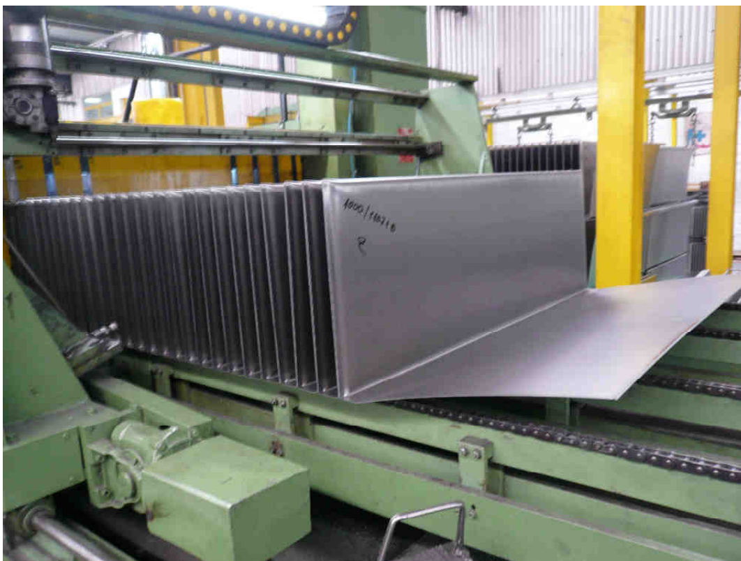
Εικόνα 3.2 - Πρέσα διαμόρφωσης πλευρικών τοιχωμάτων (πανέλλων). Έξοδος από αυτήν των διαμορφωμένων τοιχωμάτων
