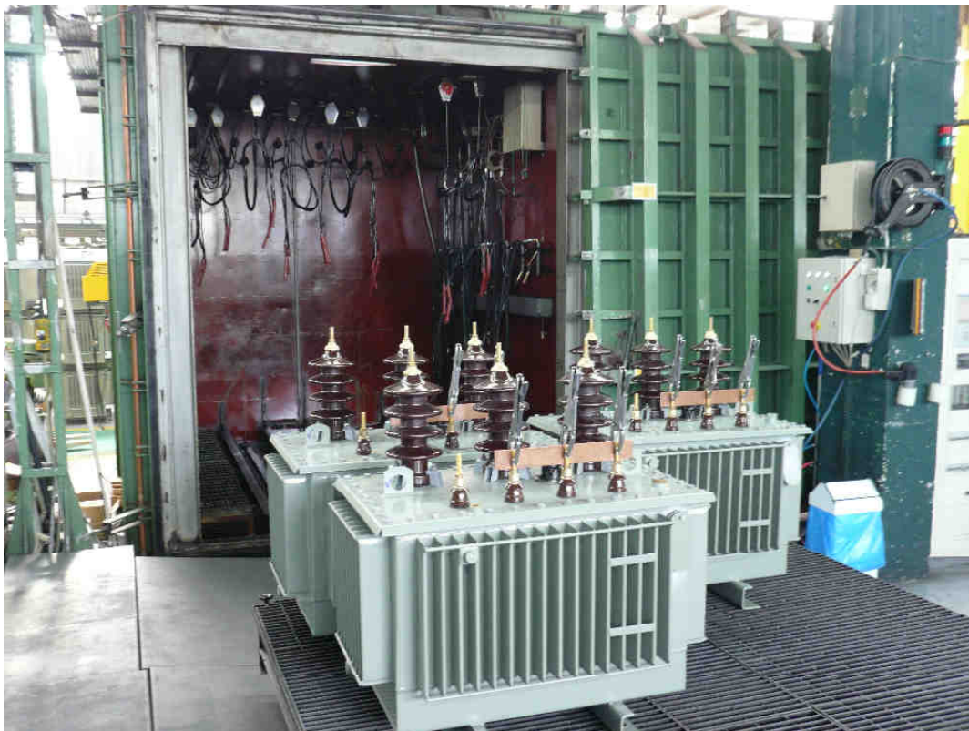
Εικόνα 3.37 - 1 ος θάλαμος ξήρανσης (μέθοδος ηλεκτρικής ξήρανσης) και κενού
