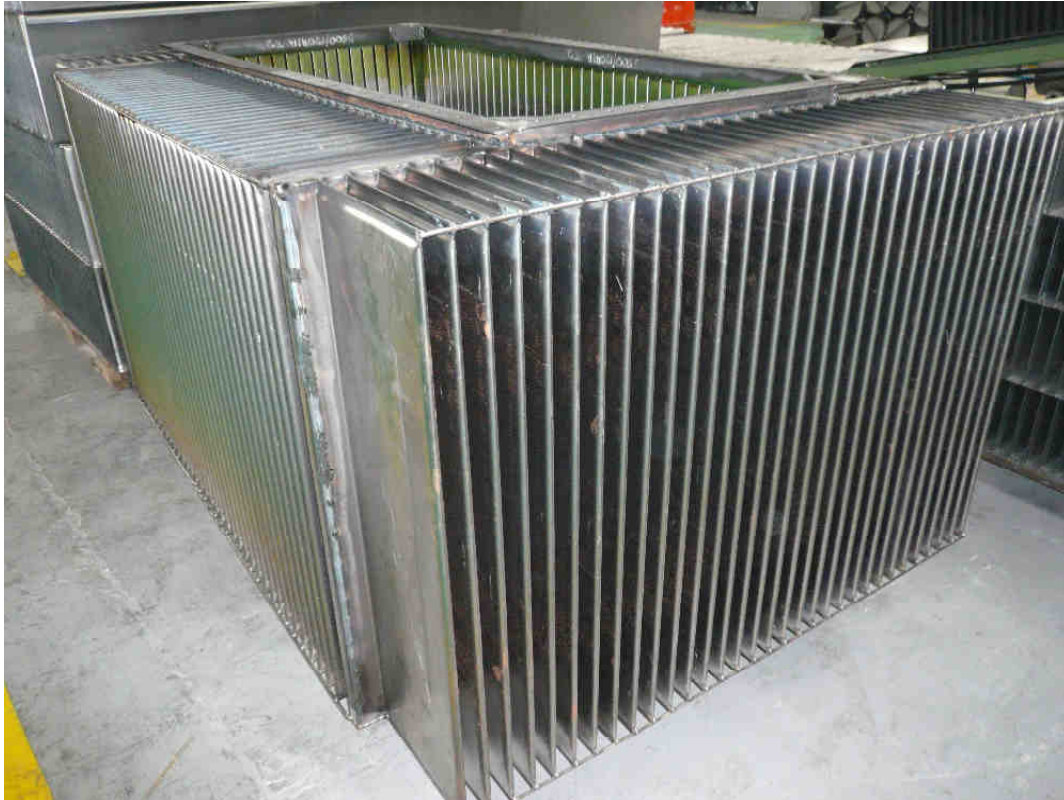
Εικόνα 3.7 - Διαμορφωμένο καζάνι για Μ/Σ 2500 kVA, μετά και τον έλεγχο στεγανότητας
