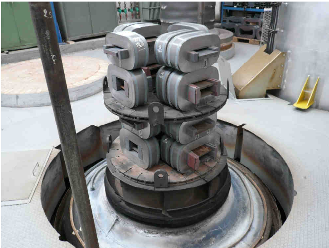
Εικόνα.3.30 - Διαμορφωμένοι πυρήνες τοποθετημένοι στον ειδικό χώρο όπου θα λάβει χώρα η διαδικασία της απόπτησης
