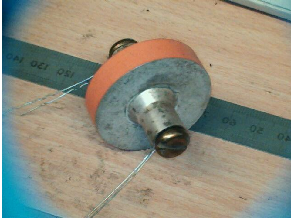
Σχήμα 4.1 Κεραμικός πυκνωτής που μπορεί να χρησιμοποιηθεί σε PLC εφαρμογές
