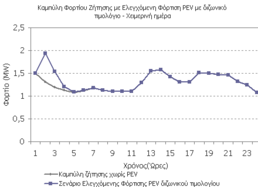
Σχήμα 3.14 Φορτίο ζήτησης, όπως διαμορφώνεται με το σενάριο της ελεγχόμενης φόρτισης των PEV's με διζωνικό τιμολόγιο – Χειμερινή ημέρα.
