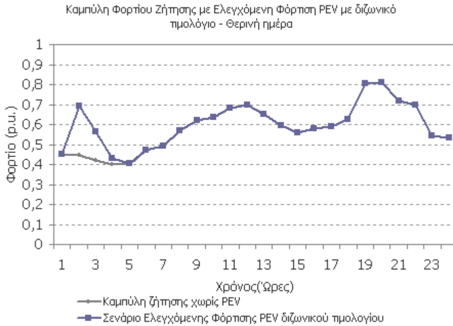
Σχήμα 4.17 Ημερήσια Καμπύλη ζήτησης συστήματος με Ελεγχόμενη Φόρτιση PEV με διζωνικό τιμολόγιο.
