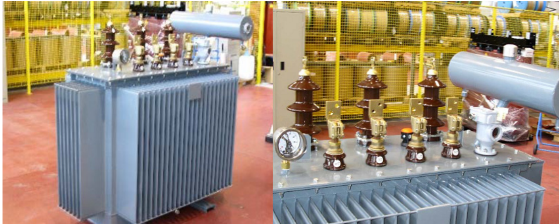
Σχήμα 1.29 Εξωτερική όψη μετασχηματιστή ελαίου.
