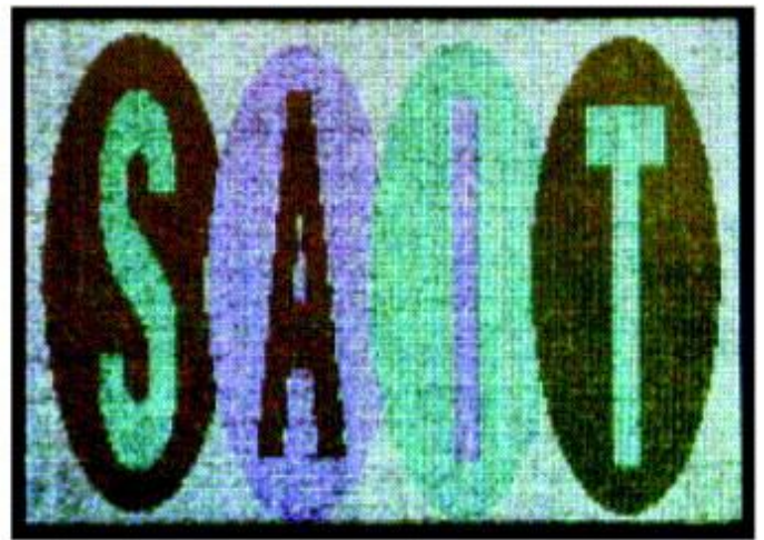
Εικόνα 2.9: Έγχρωμη εικόνες από την πρωτότυπη πειραματική οθόνη CNT-FED μεγέθους 9 ιντσών της Samsung
