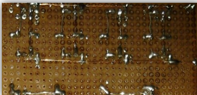
Σχήμα 4.5.2.4_Οι δύο Η-γέφυρες στην πλακέτα της κατασκευής μας.
