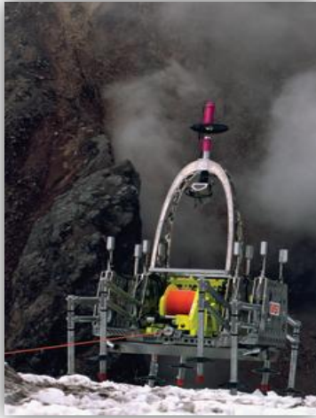
Σχήμα 1.2.1 _Βαδίζον Ρομπότ Dante II της NASA σε ανάβαση στην Αλάσκα για εξερεύνηση ηφαιστείου.
