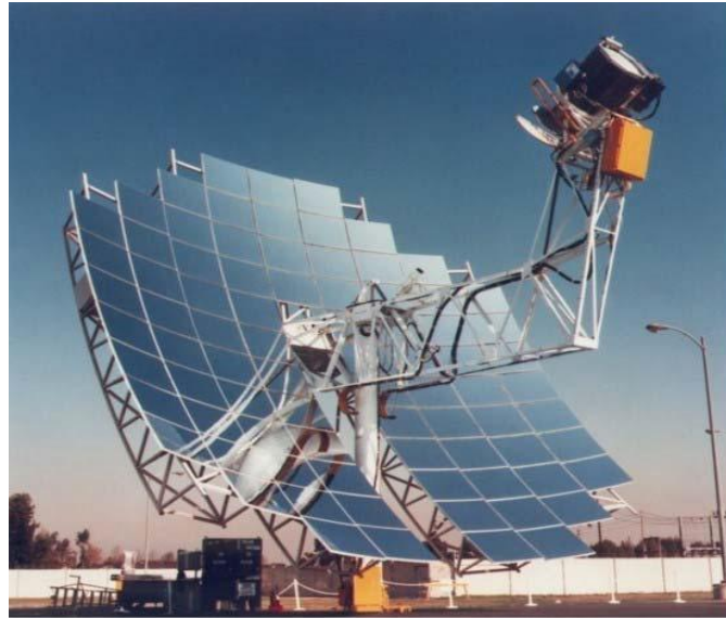
Σχήμα 2.8: Παραβολικό πιάτο με πολλές έδρες και μηχανική υποστήριξη.
