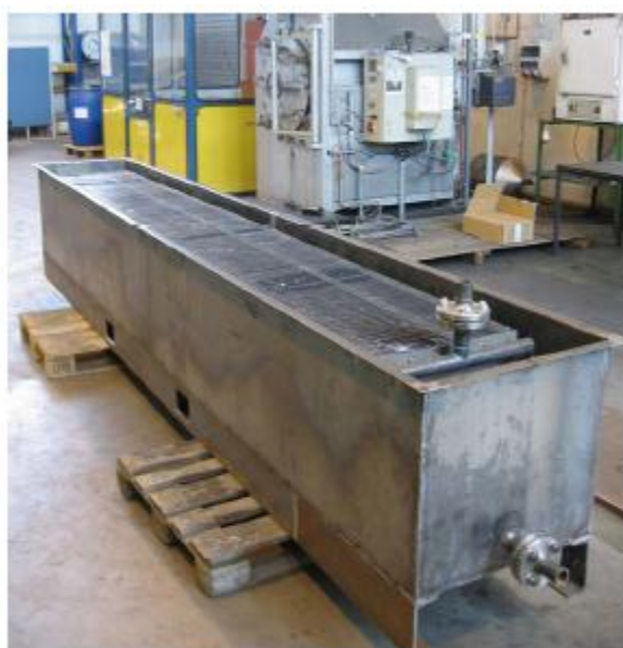
Σχήμα 5.7: Αποθήκευση θερμότητας με αλάτι αλλαγής φάσης.
