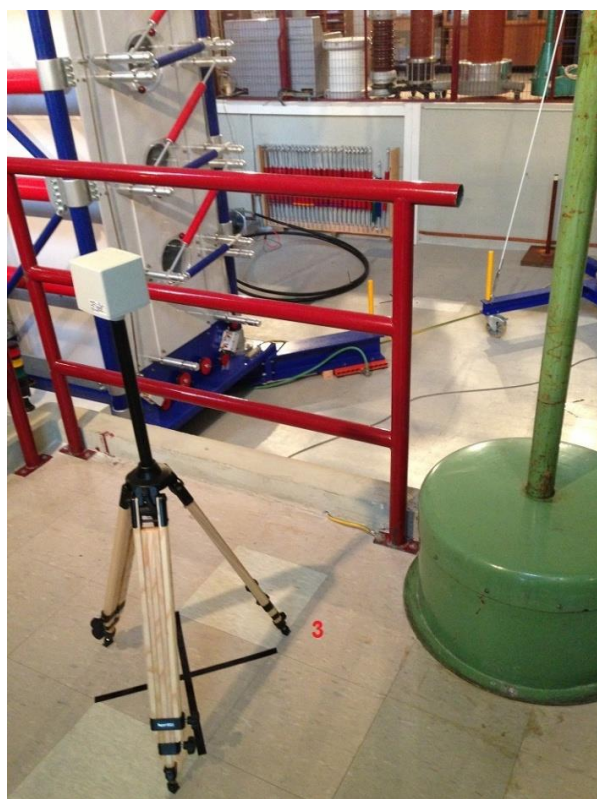
Φωτογραφία 5.4: Θέση μέτρησης 3 του μαγνητικού πεδίου. Κάτω στο βάθος φαίνεται ο ρευματοφόρος αγωγός.
