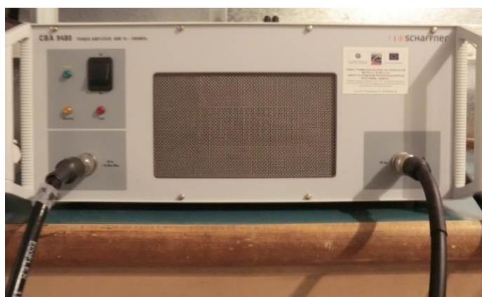
Φωτογραφία 6.7: CBA 9480 Power Amplifier 60 Watt της Schaffner
