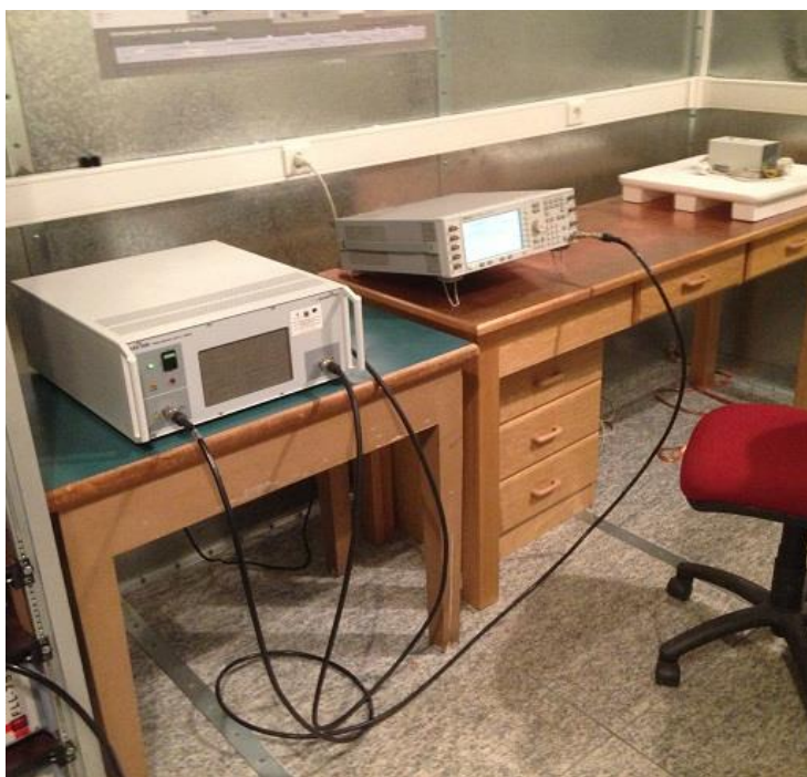
Φωτογραφία 6.5: Δωμάτιο ελέγχου όπου βρίσκονται οι γεννήτριες σημάτων μαζί με τους ενισχυτές
