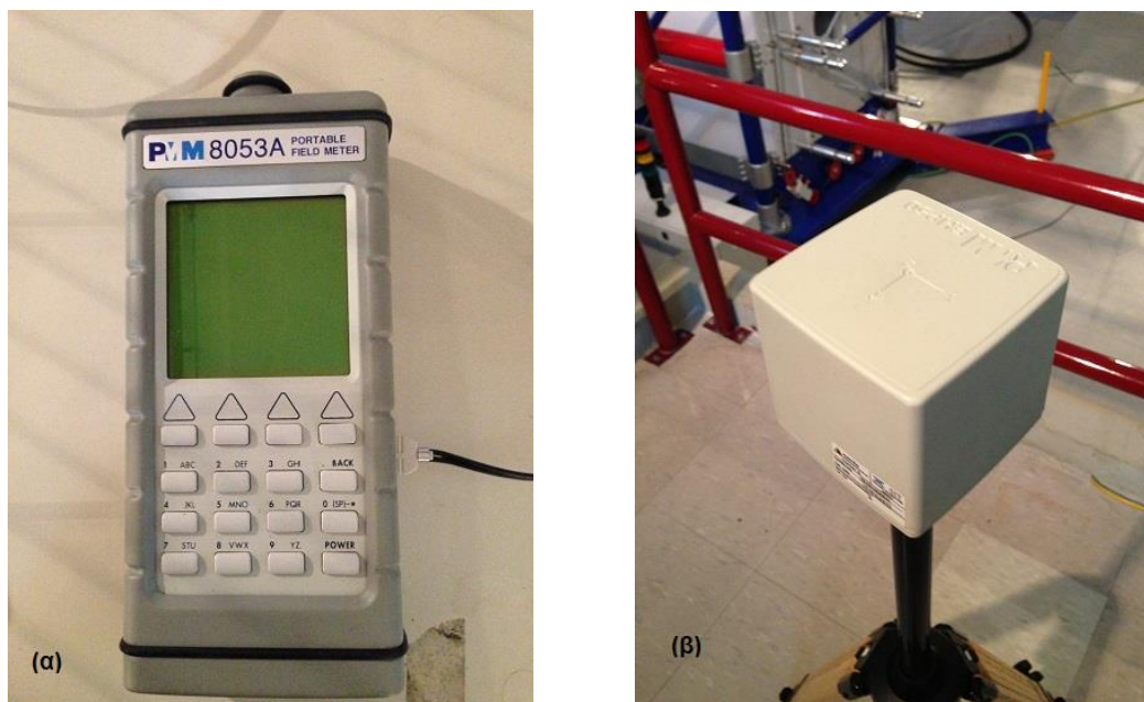
Σχήμα 4.5: (α) Πεδιόμετρο PMM 8053 και (β) αισθητήρας χαμηλόσυχνων πεδίων
