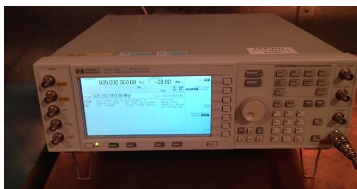
Φωτογραφία 6.6: E444338 Signal Generator της Hewlett Packard
