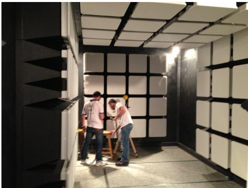
Φωτογραφία 6.1: Ανεχτικός θάλαμος Ε.Υ.Τ.Ε.Μ.Π. Στο βάθος φαίνεται η θέση μέτρησης καθώς και το probe του μετρητή που είναι τοποθετημένο στο 1.5 m.
