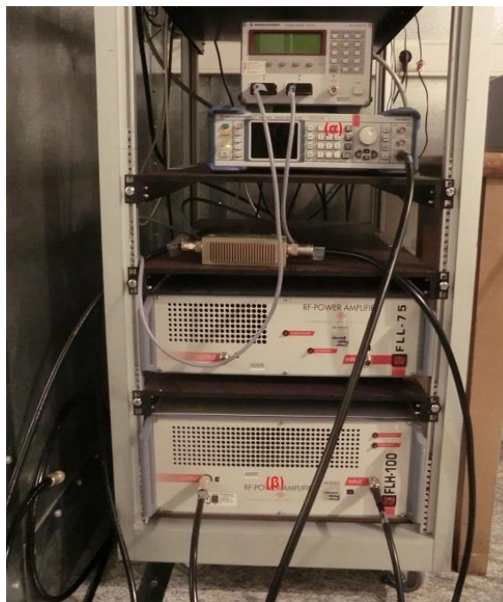
Φωτογραφία 6.8: (α) Γεννήτρια SMB 100A της Rohde & και (β) Ενισχυτής FLH-100 RF της Frankonia
