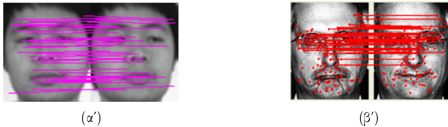
Σχήμα 64: Ταίριασμα SIFT (α) και SURF (β) χαρακτηριστικών μεταξύ 2 διαφορετικών φωτογραφιών του ίδιου προσώπου
