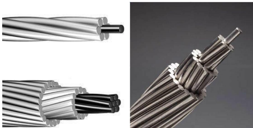
Σχήμα 3.1.3-1: ASCR αγωγοί - Οι εξωτερικοί κλώνοι από αλουμίνιο προσδίδουν μεγάλη ειδική αγωγιμότητα ενώ οι εσωτερικοί από χάλυβα αποτελούν τη "χαλύβδινη ψυχή" που προσδίδει τη μηχανική αντοχή στους αγωγούς
