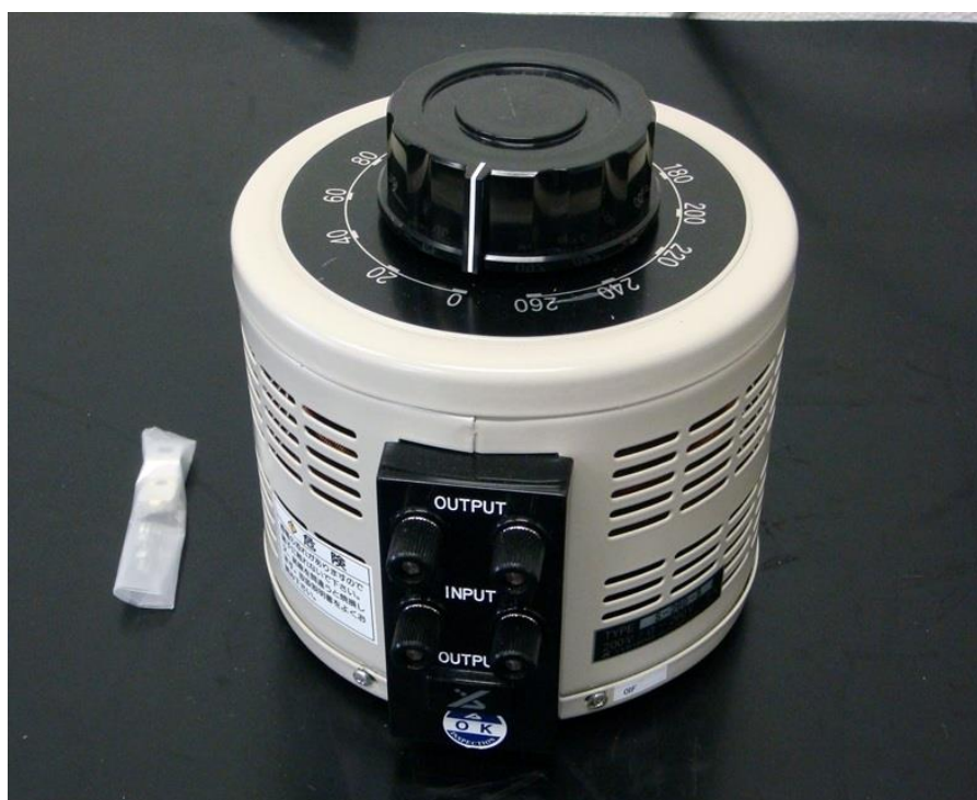
Σχήμα 3.1.1-1: Η φωτογραφία του μετασχηματιστή μεταβλητής εξόδου ενδιάμεσης λήψης VARIAC
