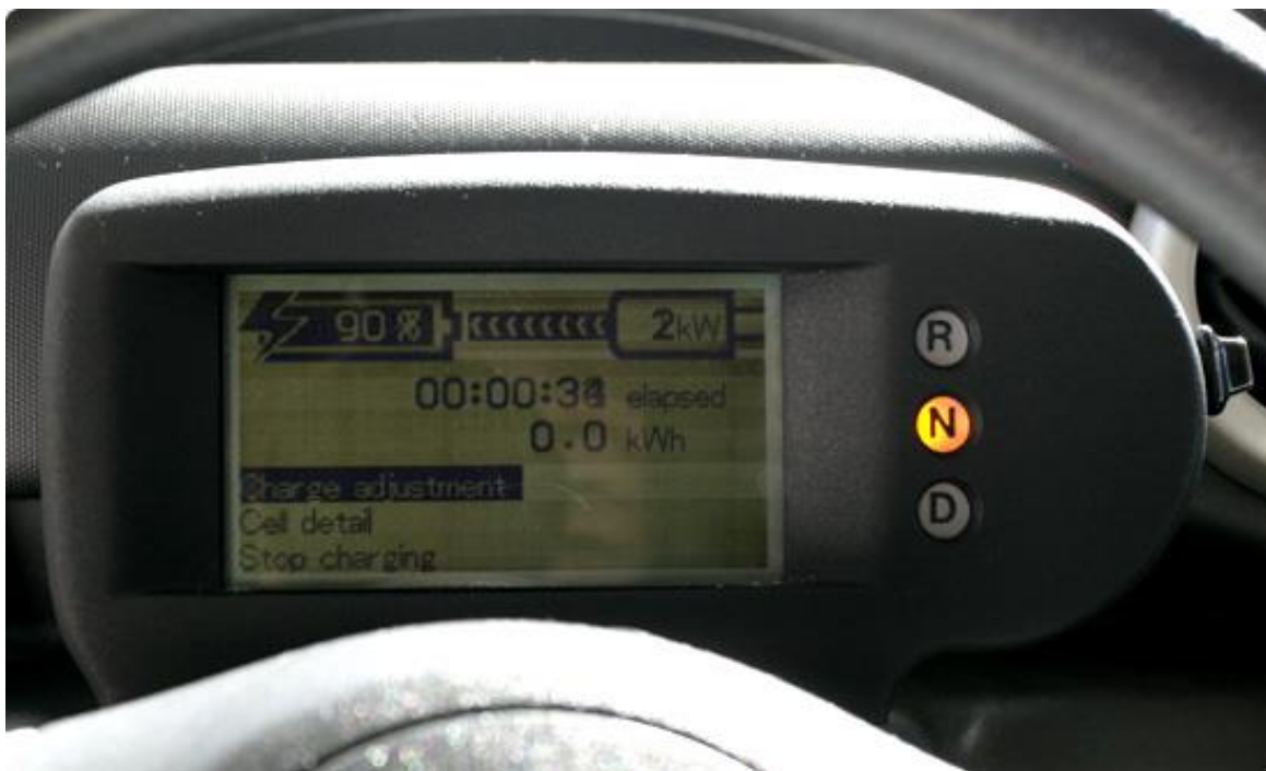
Εικόνα 9 - Πάνελ ρύθμισης φόρτισης εντός του οχήματος
