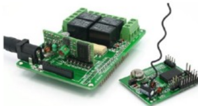
Εικόνα 33: Πλακέτα Relay Shield με ενσωματωμένο 315M RF για ασύρματη επικοινωνία.
