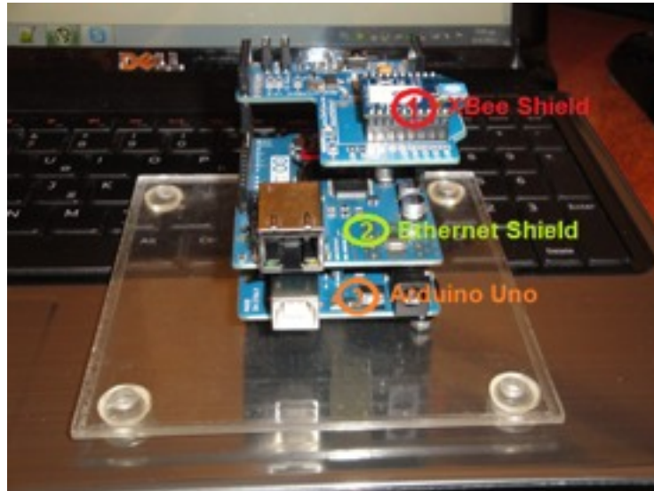
Εικόνα 49: Υλοποίηση Κόμβου Σταθμού Βάσης.
