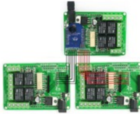
Εικόνα 35: Ένα RFBee ελέγχει τρεις πλακέτες Relay Shield.
