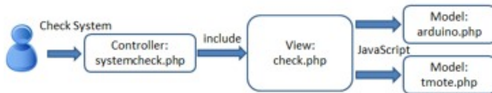
Εικόνα 64: Λογική λειτουργίας κατάστασης ελέγχου περιφερειακών δικτύων.
