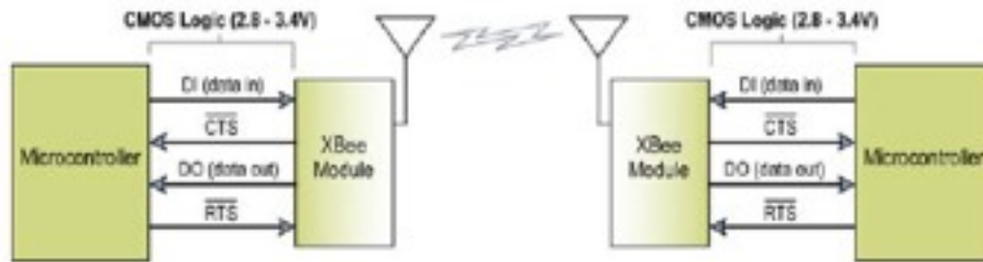
Εικόνα 37: Λογική λειτουργίας της μονάδας XBee module.
