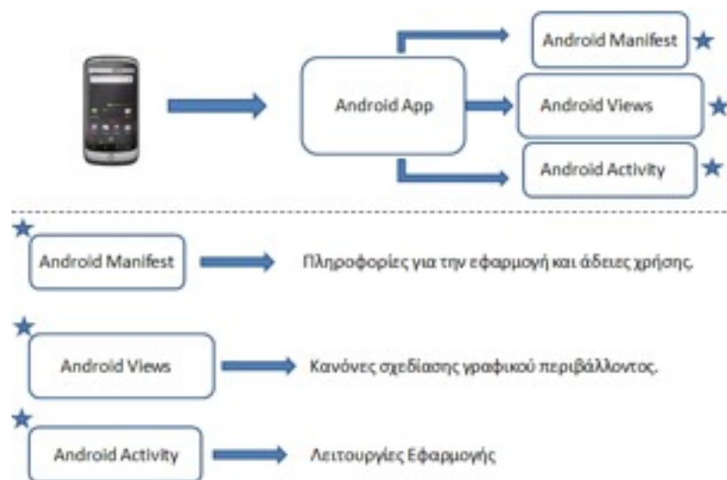
Εικόνα 66: Λογική υλοποίησης Εφαρμογής Android.
