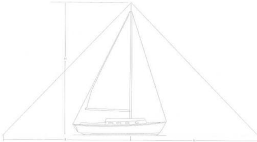
Εικόνα 3.2.1.1: Ζώνη προστασίας για κατάρτι κάτω των 30m από το νερό
