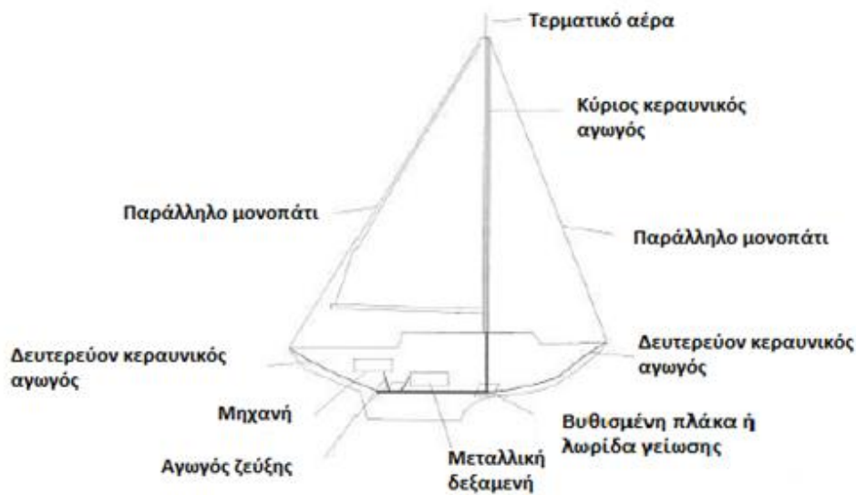
Εικόνα 3.2.1.4: Σύστημα αντικεραυνικής προστασίας
