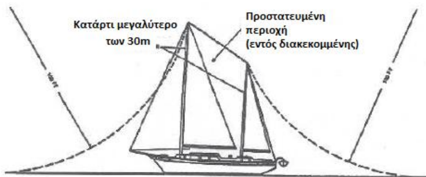
Εικόνα 3.2.1.3: Μέθοδος κυλιόμενης σφαίρας
