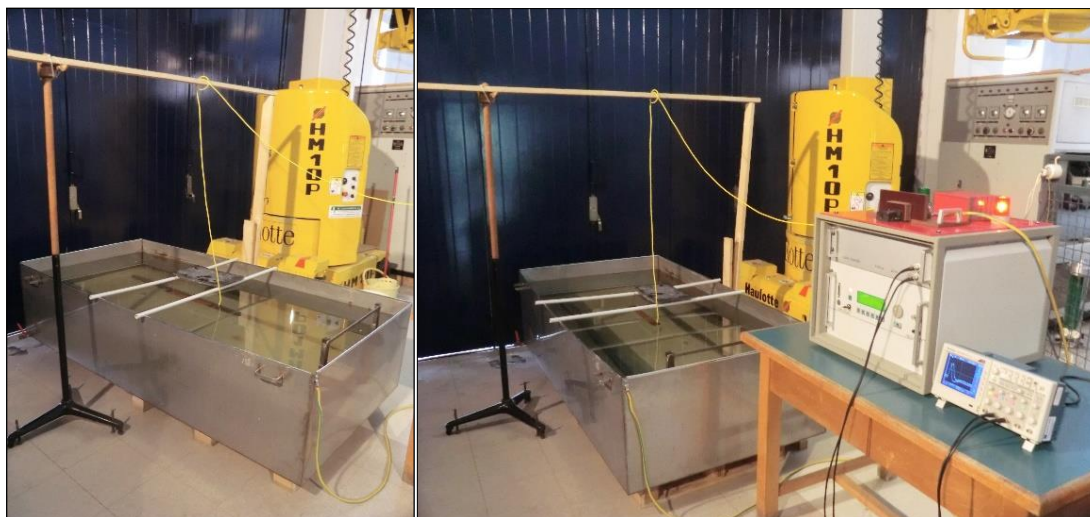
Εικόνες 4.13-4.14: Μηχανισμός στήριξης του καλωδίου τροφοδότησης και συνολική εικόνα της διάταξης
