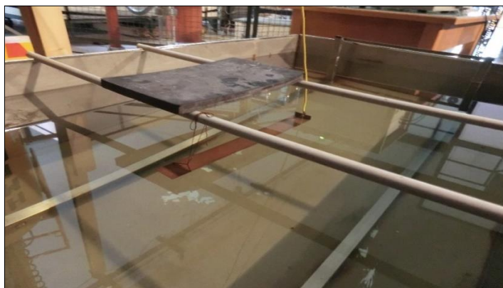
Εικόνα 4.12: Μηχανισμός στήριξης ηλεκτροδίου μέσα στη δεξαμενή
