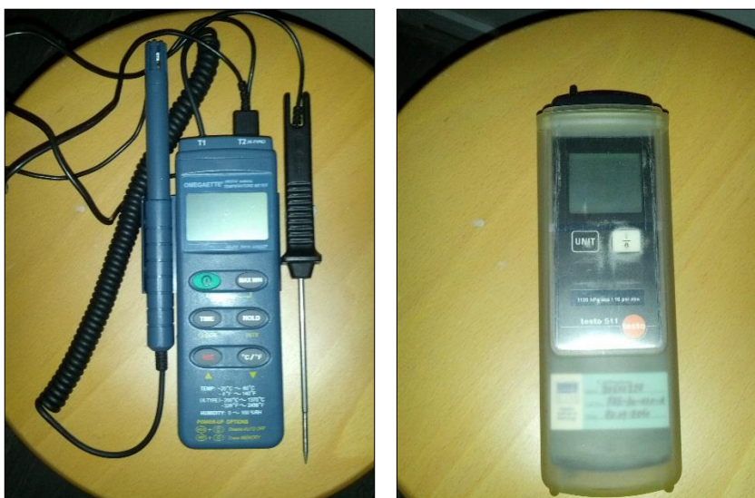
Εικόνες 4.9-4.10: Θερμόμετρο OMEGAETTE και υγρόμετρο Testo 511
