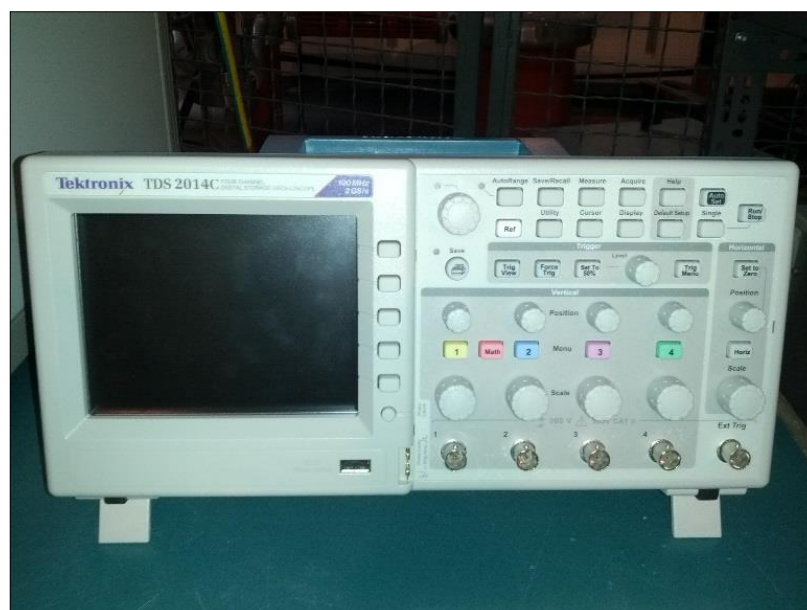
Εικόνα 4.6: Εμπρόσθια όψη παλμογράφου Tektronix TDS 2014C
