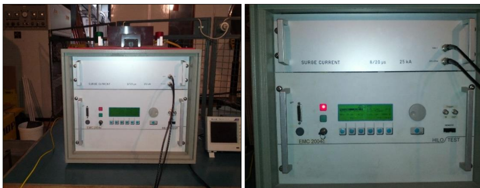
Εικόνες 4.2-4.3: Κρουστική γεννήτρια ρεύματος HILO-TEST:EMC-2004
